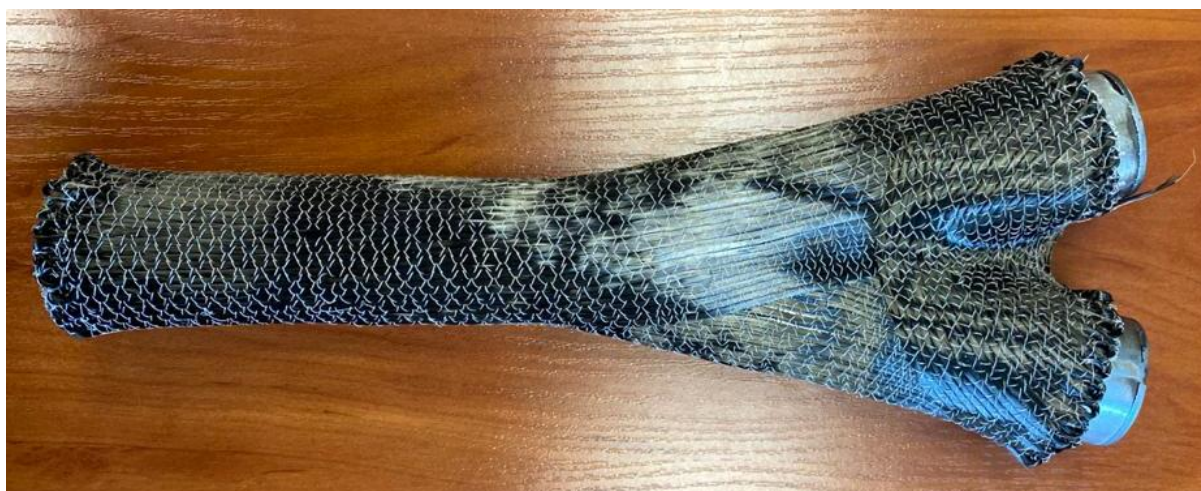
Рисунок 4.13 – Примерка преформы на оправке
