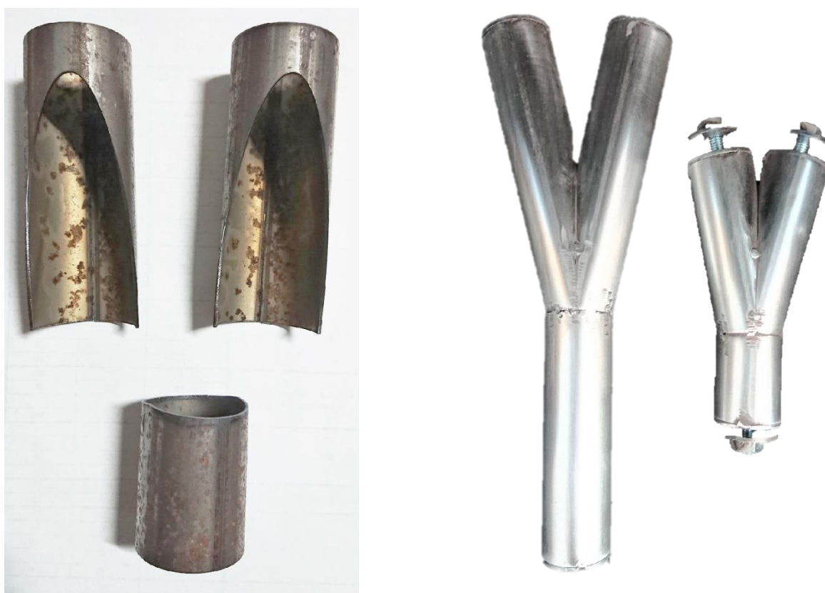
Рисунок 3.37 – стальная оправка для тестирования преформы (цельная и разборная)
