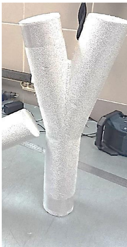
Рисунок 3.33 – Оправка из двух пенополистирольных половинок
