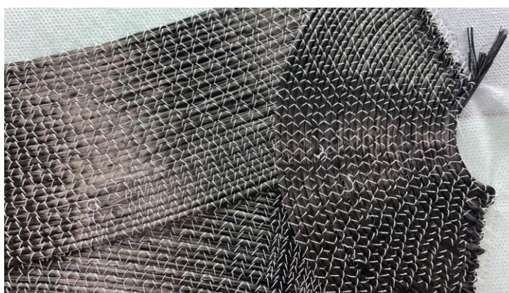
Рисунок 4.11 - Готовая преформа одной из половин Y-фитинга
