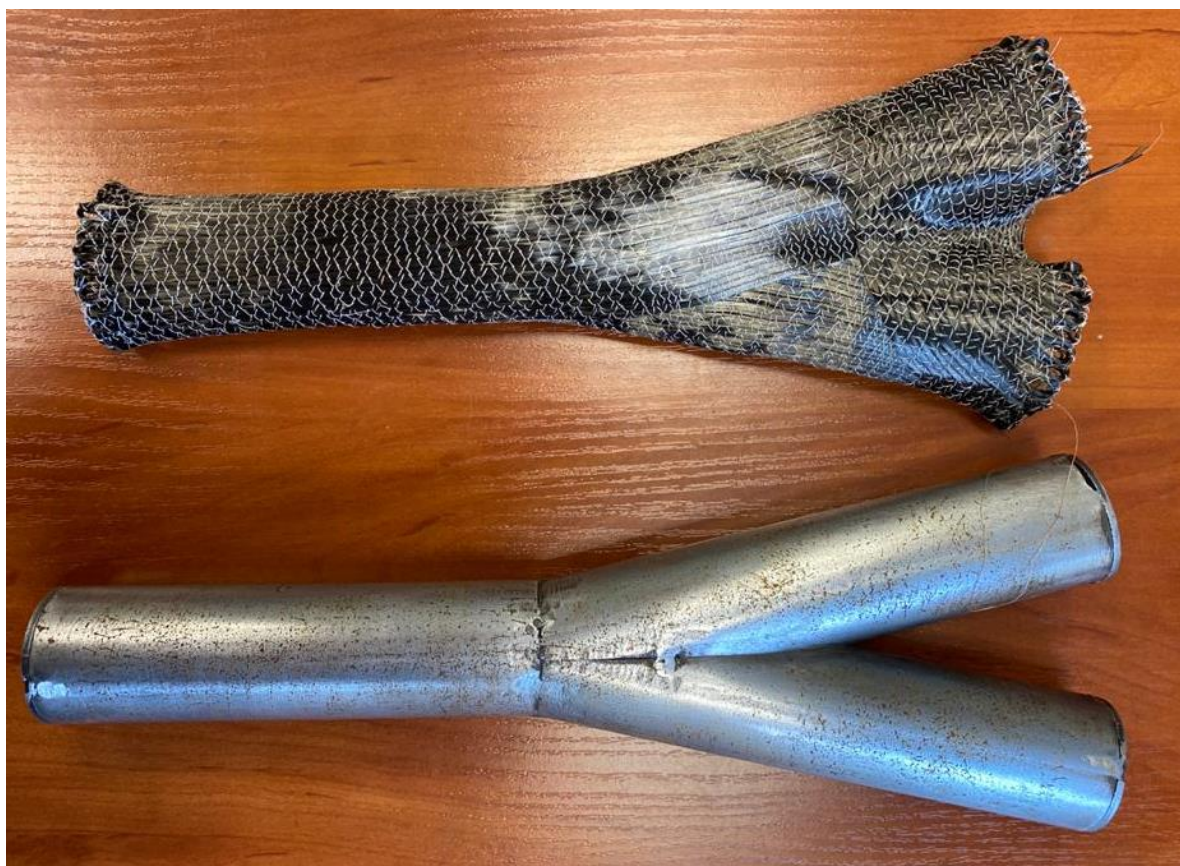
Рисунок 4.12 – Преформа приняла форму оправки после сушки
