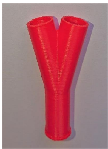
Рисунок 3.32 – Оболочка Y-фитинга напечатанная на 3д принтере
