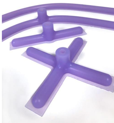
Рисунок 3.30 – Силиконовая формообразующая оправка с подачей смолы.
