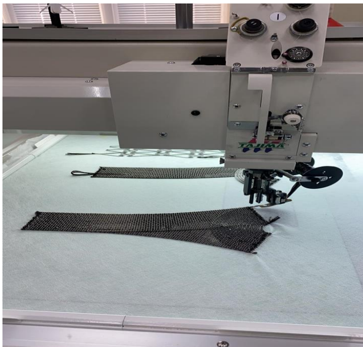
Рисунок 4.10 - Процесс выкладки волокна технологией TFR
