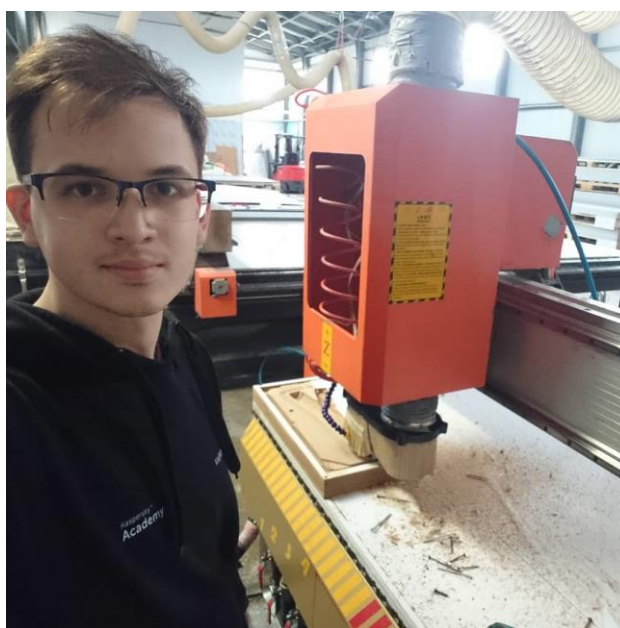
Рисунок 3.26 – фрезеровка формообразующей оснастки (матрица)
