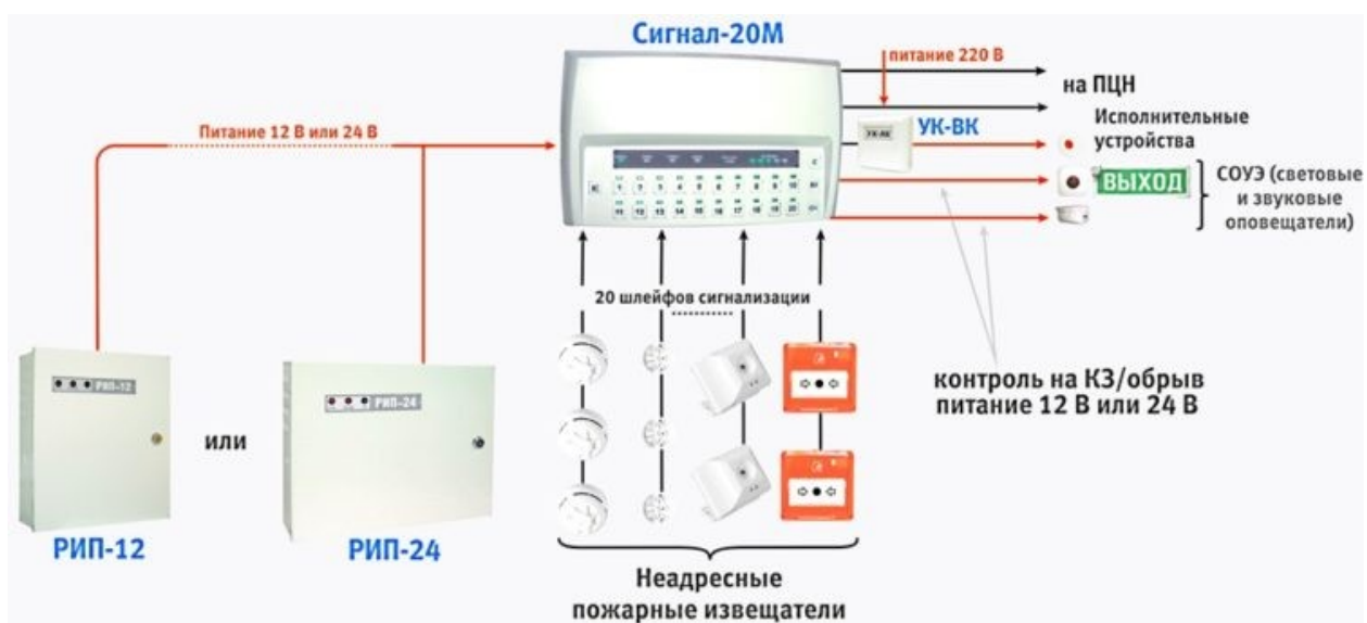
Рис. 3.7 – Структурная схема автоматической пожарной сигнализации в составе САПСПТ
