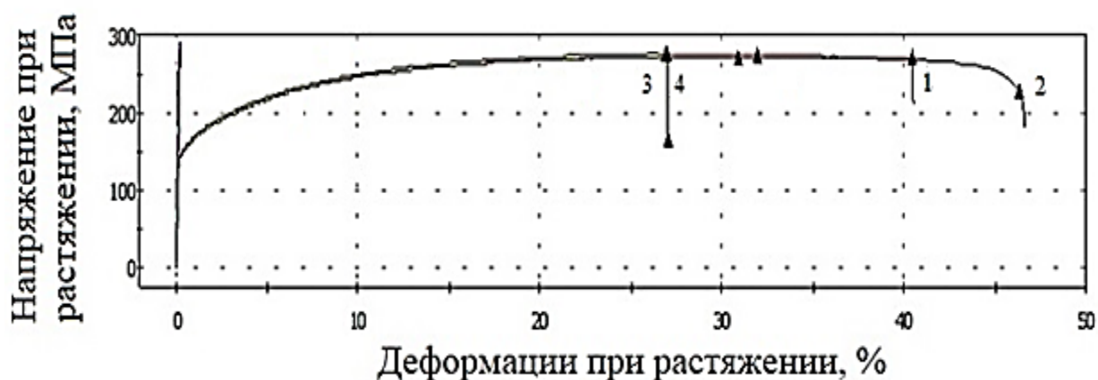
Рисунок 24 – Зависимость напряжений от деформации для образцов стали 40X
