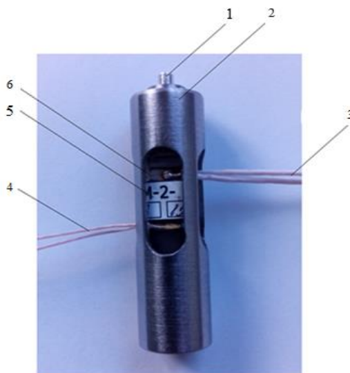
1 – толкатель, 2 – корпус МЛП, 3 – выводы датчика силы, 4 – выводы пьезоактюатора, 5 – пьезоактюатор АПМ 2-7, 6 – датчик силы
