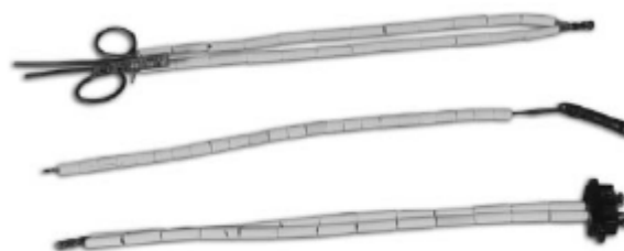
в) внешняя термопара типа ХА
