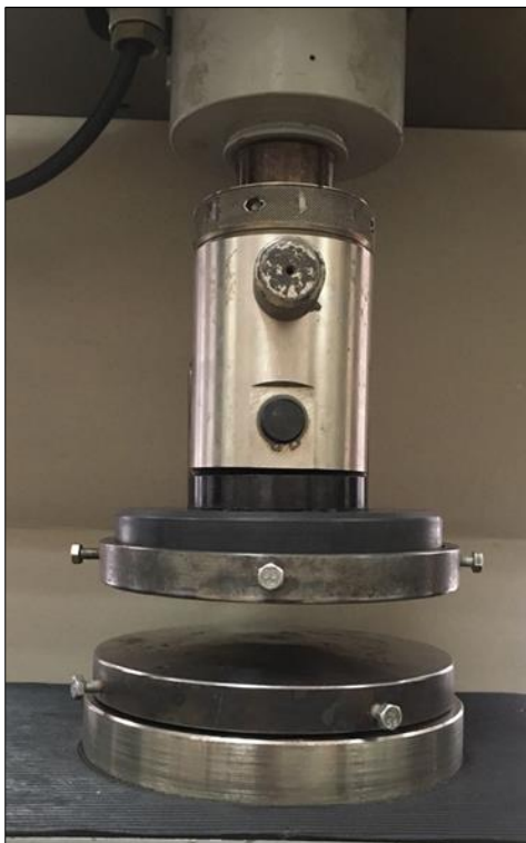
в) захваты для испытаний на осадку (сжатие)
