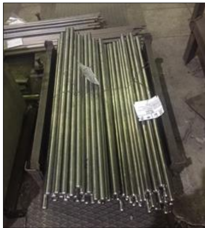
Кованный пруток \varnothing 25 мм
