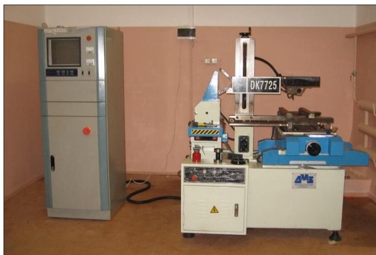
а) электроэрозионный станок
