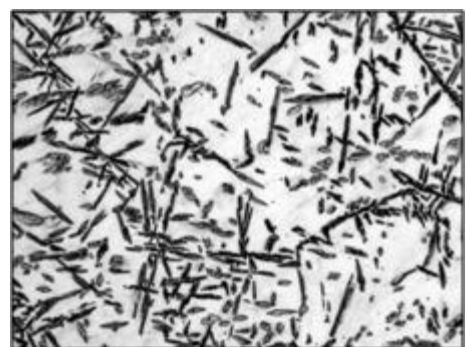
з) VT15: закалка с 800°, вода + старение 600°, 40 часов
