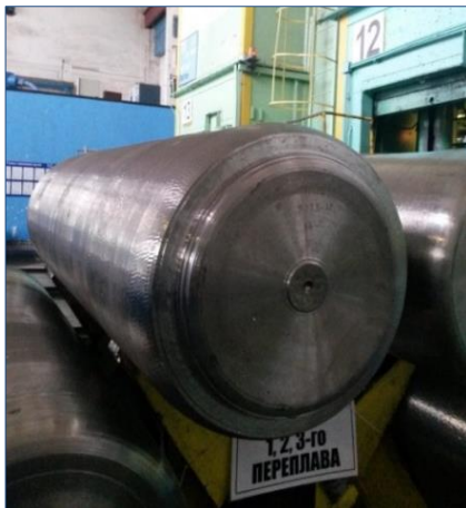
Промышленный слиток \varnothing 435 мм
