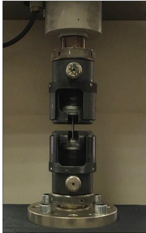
б) захваты для испытания на одноосное растяжение
