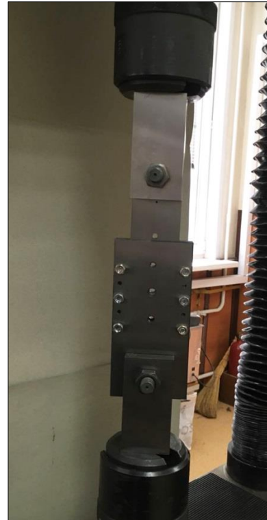
г) захваты для испытания на срез
