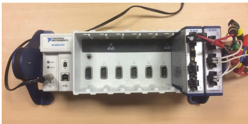
Рисунок 2.5 – Внешний вид системы измерения мгновенных значений токов и напряжений
