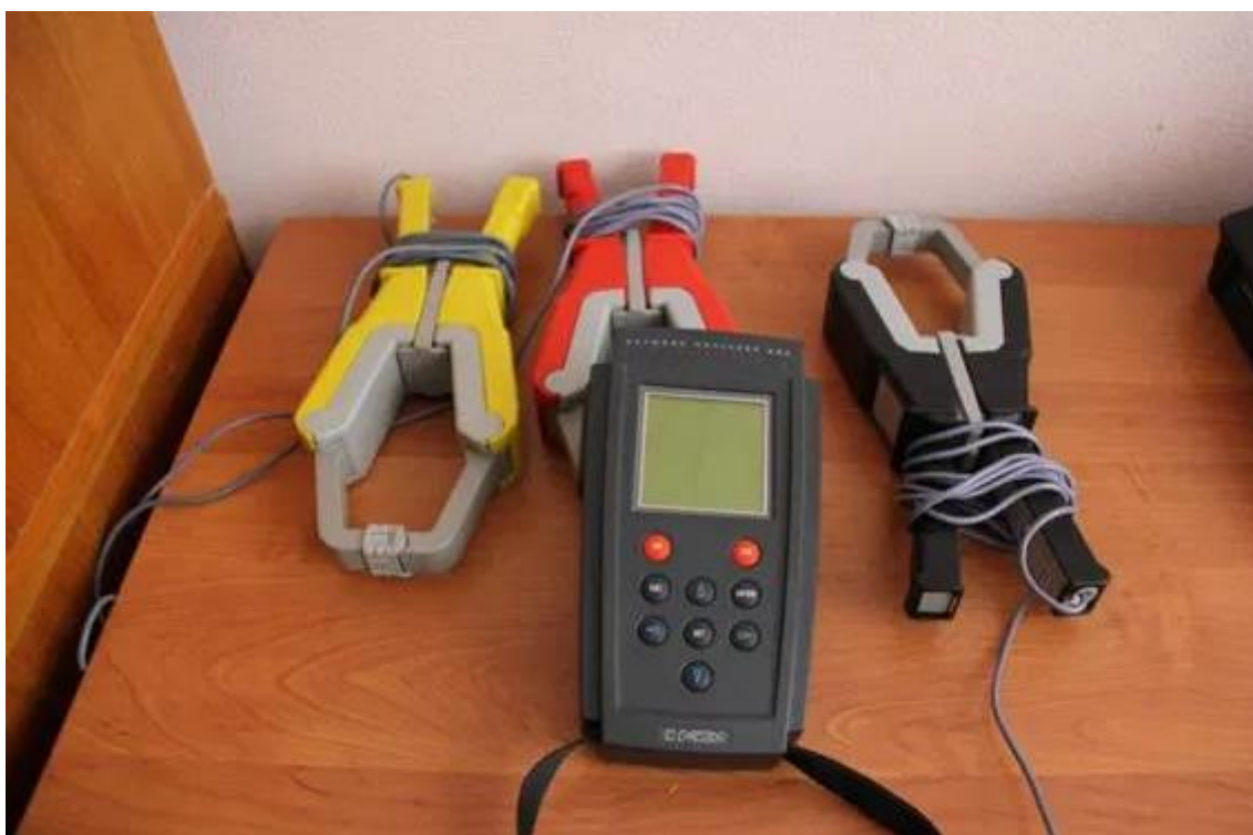
Рисунок 2.1 – Внешний вид анализатора AR5.M с токоизмерительными клещами на 200 А
