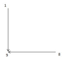
$$V_{\text{p1-9}} + V_{\text{p9-8}} - V_{\text{y3л.9}} = 0$$
