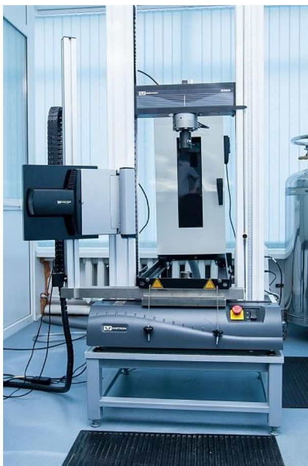
Рисунок 3 – Универсальная электромеханическая испытательная машина Instron 3369
