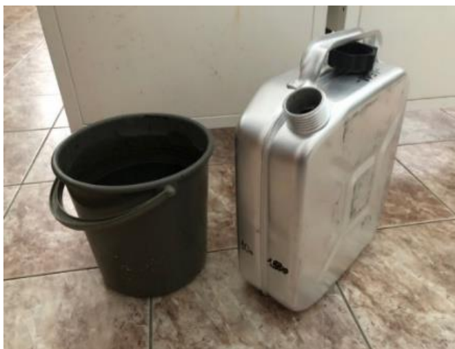
Рис.3.14 Использование канистры для моделирования процесса анаэробного сбразживания осадка.
