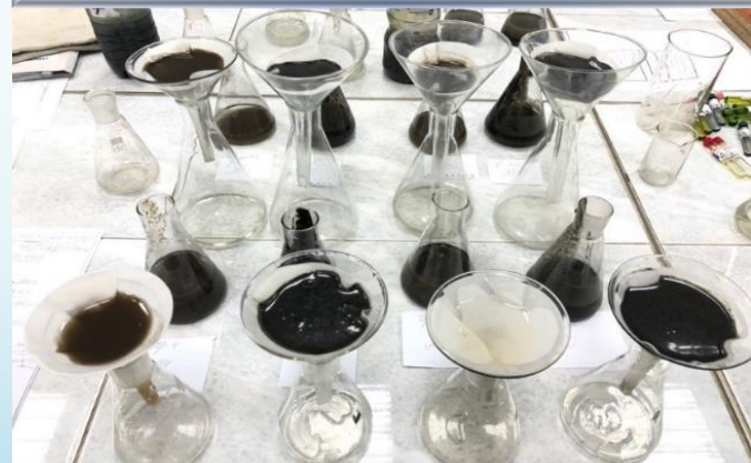
Фильтрация сырого осадка и избыточного активного ила
