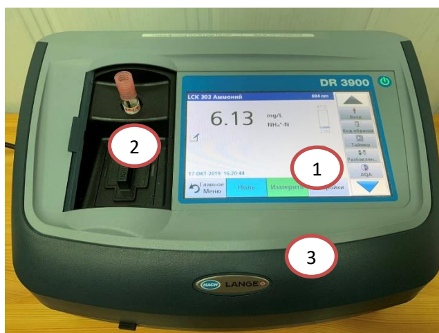
Рисунок 2.7 Спектрофотометр DR-3900 1-дисплей; 2-ячейка для многоцелевых кювет; 3-корпус
