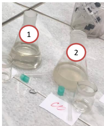
Рис. 3.11 Профильтрованные пробы 1 – фильтрат активного ила; 2 – фильтрат сырого осадка
