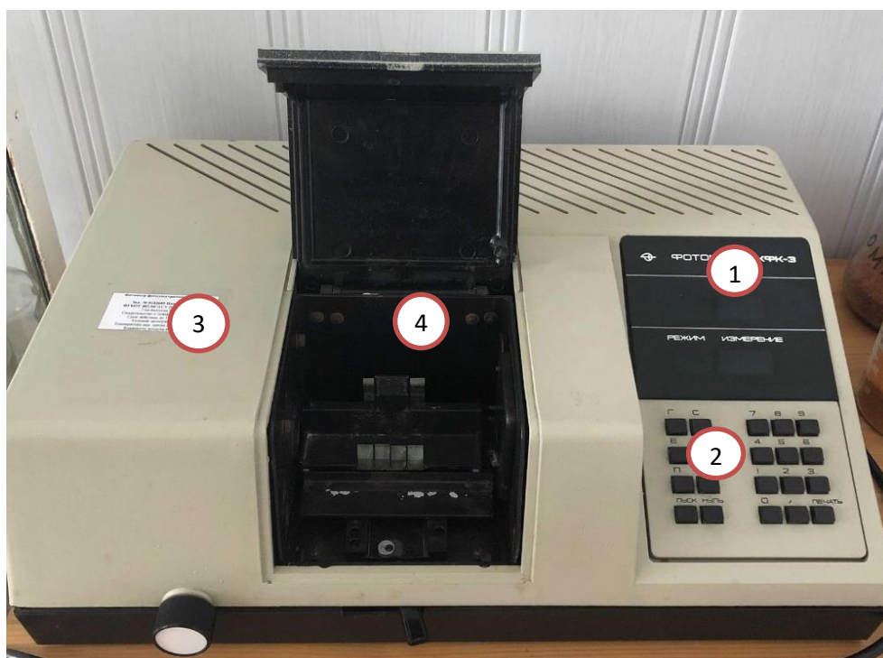
Рис. 2.5 Фотоэлектроколориметр КФК – 3 1–дисплей; 2–клавиатура; 3–корпус; 4–ячейка для кюветов
