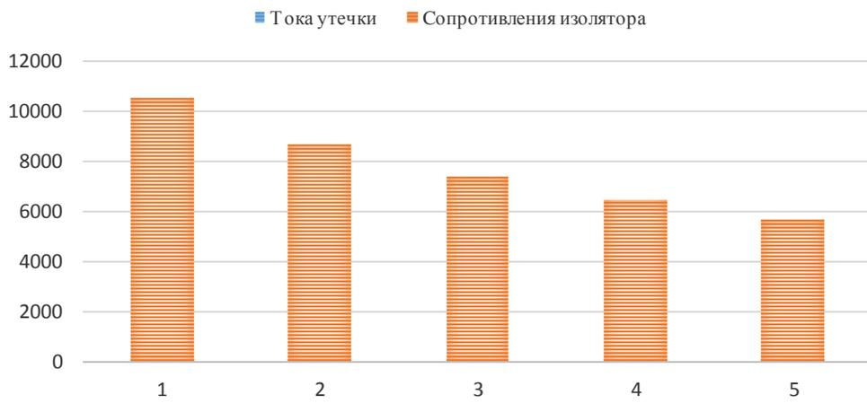
график тока утечки как функции сопротивления изолятора зоны высокого загрязнения
