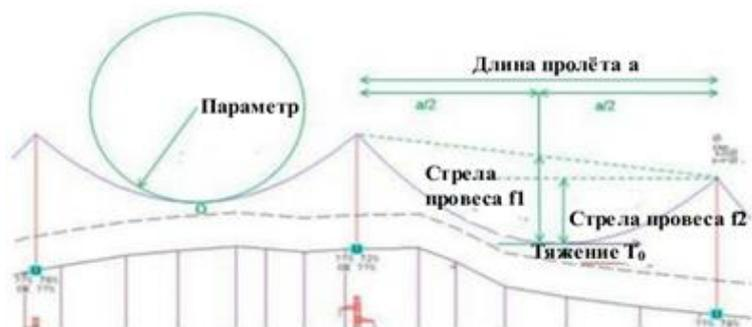
Рисунок 2.1 – Схема, представляющая различные геометрические величины линии
