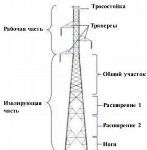
Рисунок 1.15 – Различные части опор
