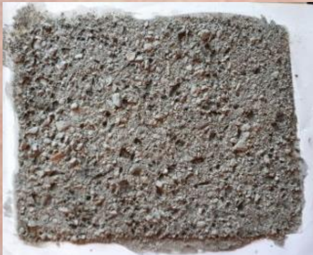
Рисунок 4.8 – Внешний вид гибкого камня с декоративным слоем из гранитной крошки
