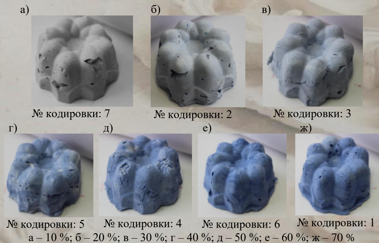
Рисунок 2.3 – Внешний вид образцов прокрашенных в массу в синий цвет с разным содержанием колера
