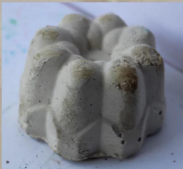
Рисунок 2.13 – Внешний вид образца, подверженному воздействию соляной кислоты
