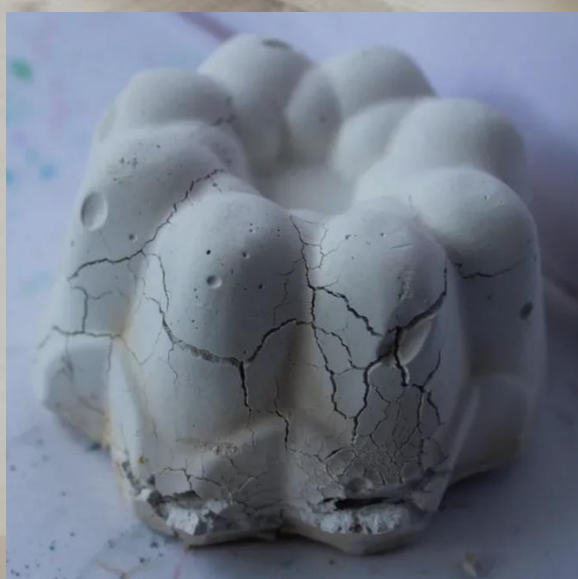
Рисунок 2.14 – Внешний вид образца, подверженный тепловому старению
