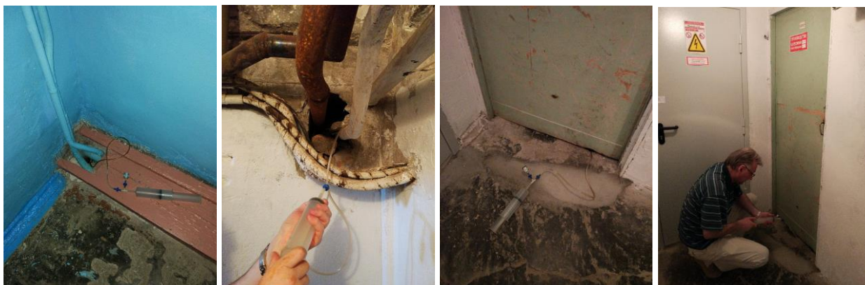
Рисунок 3.7 – Примеры отбора проб воздуха из щелей и закрытых помещений
