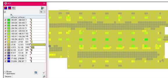
Изополя напряжений M_y в перекрытие второго этажа на отм. +3,300, кН·м/м
