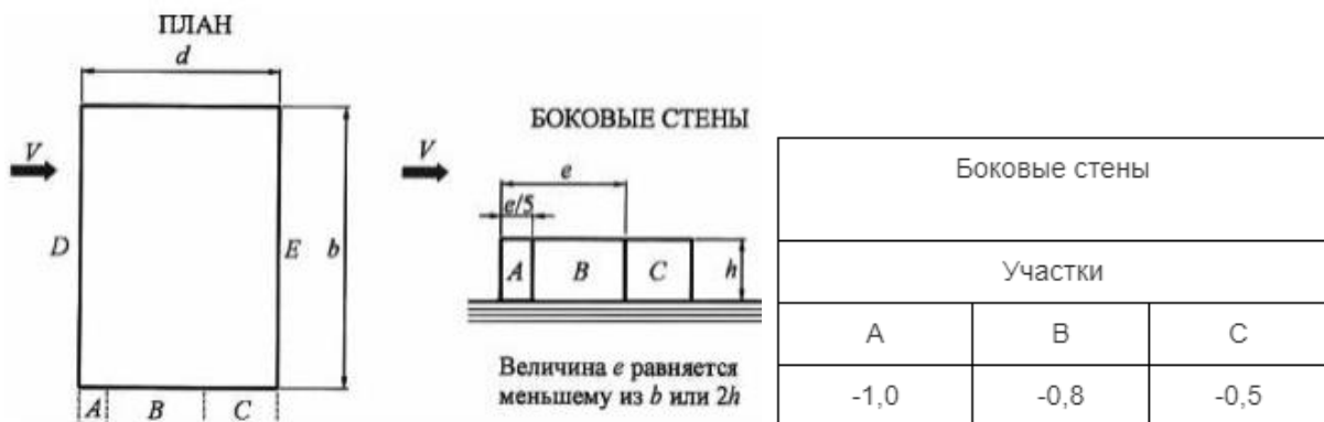
Рисунок 1.8 – Значение коэффициента c_e для различных участков вертикальной стены
