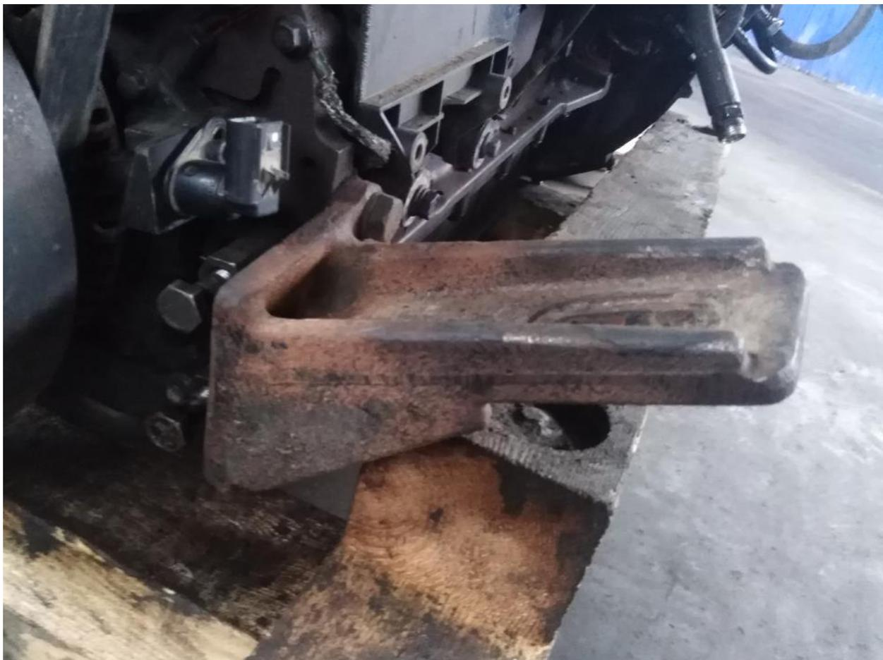
Рис. 3.11. Передний кронштейн двигателя (вид сбоку)
