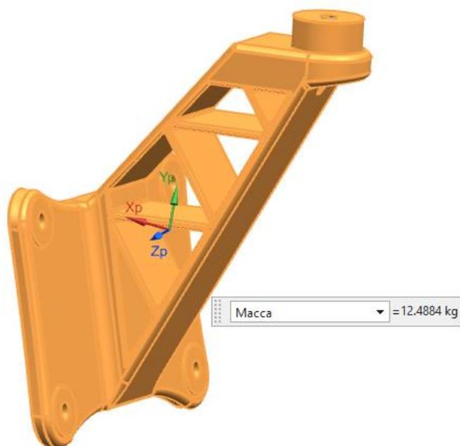
Рис. 3.33. Измерение массы детали
