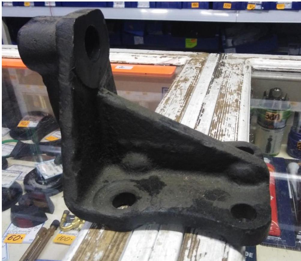
Рис. 3.13. Задний кронштейн двигателя
