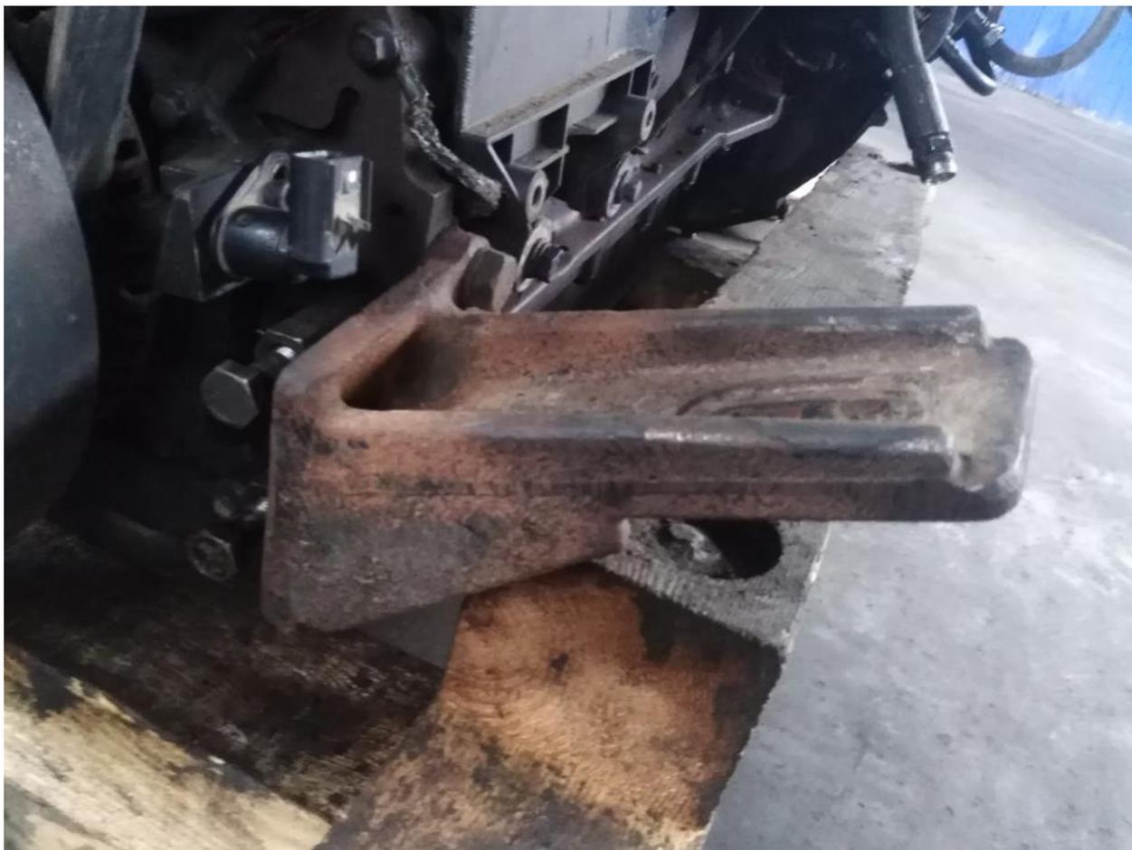
Рис. 3.4. Передняя опора двигателя КАМАЗ
