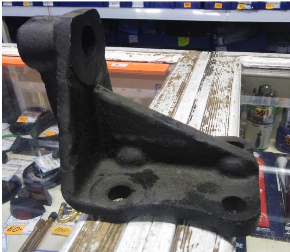
Рис. 3.5. Задний кронштейн двигателя КАМАЗ
