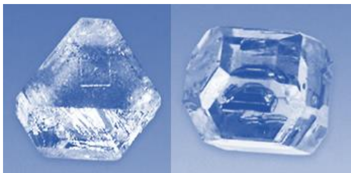
Рисунок 1.10 – Фотографии алмазов, выращенных на затравках с ориентациями (111) и (100)
