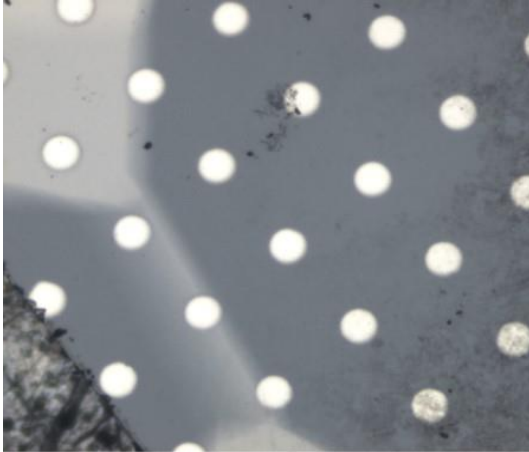
Рисунок 3.2 – Фотографии фрагментов образцов П 4 и П 9 со сформированными на них массивами диодов Шоттки
