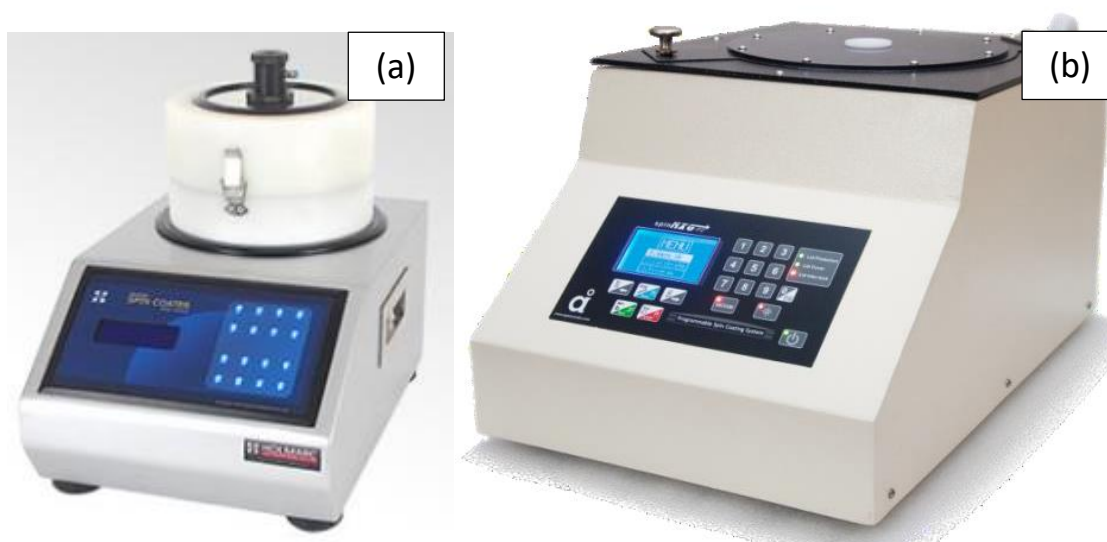
Рисунок 10 – Оборудование для метода центрифугирования НО-ТН-05 (а), АРЕХ spinNXG (b)
