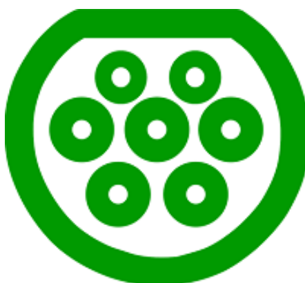
Рисунок 1.10 Электромобильный коннектор с разъемом GB/T 20234 переменного тока (AC)
