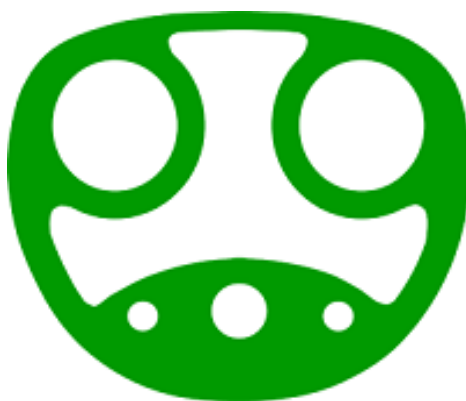
Рисунок 1.4 Разъем Tesla Supercharger (США)
