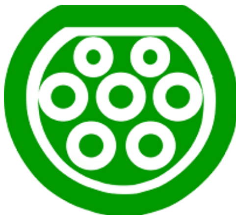
Рисунок 1.6 Тип разъема Type 2 Mennekes (Европа)
