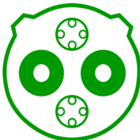
Рисунок 1.7 Тип разъема CHAdeMO (США/Япония/Европа)
