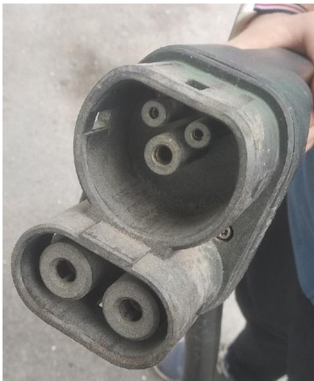
Рисунок 3.3 Разъем для зарядки электробуса
