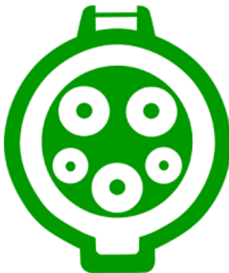
Рисунок 1.5 Тип разъема Type 1 J1772 (США/Япония)
