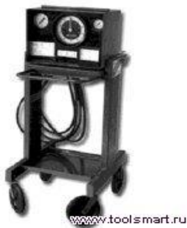
Рисунок 2.5 – Установка для проверки гидросистем рулевого управления К-465
