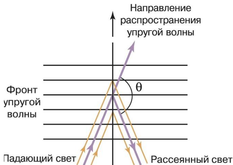
Рис. 6. Рассеяние света на упругой волне [12]
