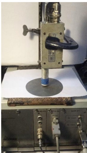
Рисунок 4 – Спектрометрическая система «АЛДАН» и тритиевая мишень
