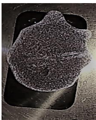
Рисунок 2.8 – Вид плёнки через 30 минут (окончание кристаллизации)
