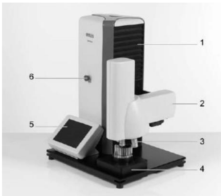
Рисунок. 3.13. Прибор для измерения микротвердости материалов «Durascan-20»: 1 – стойка устройства; 2 – испытательный узел; 3 – турель с индентором и объективами; 4 – испытательный столик; 5 – блок управления; 6 – кнопка аварийного выключения
