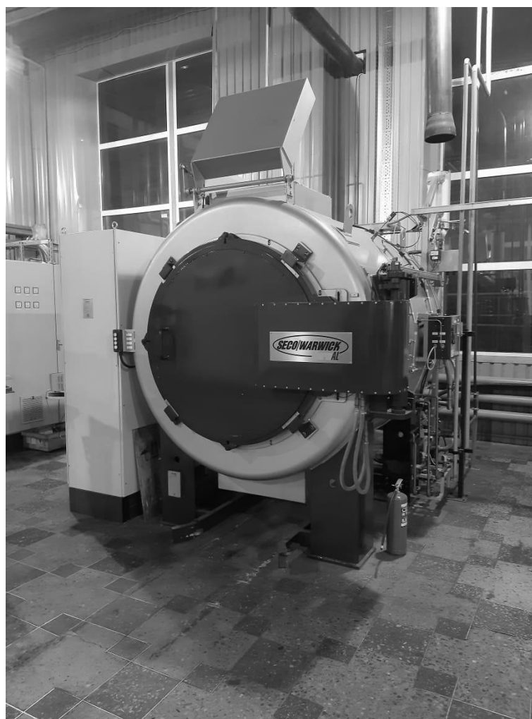
Рисунок 3.6. Вакуумная ретортная печь для термообработки с системой газового азотирования «ZeroFlow»
