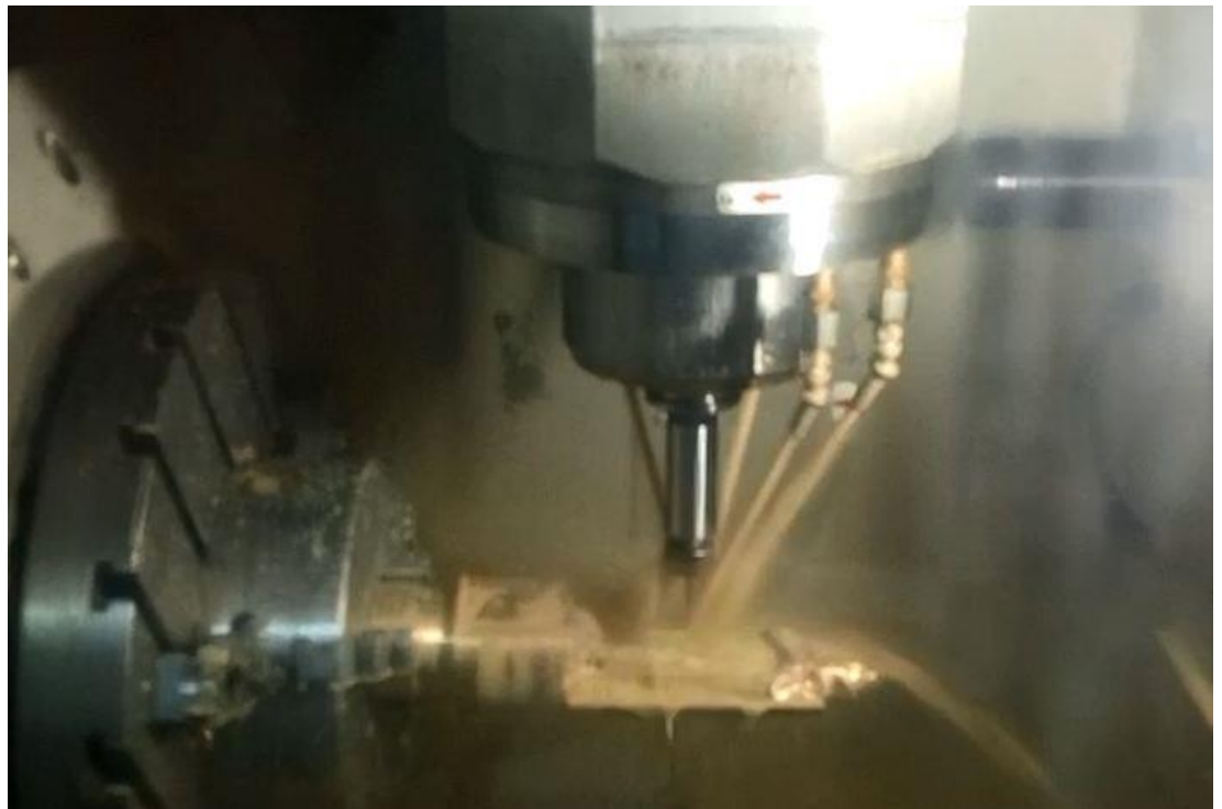
Рис. 68. (б) Идет фронтальная черновая обработка поясничной части скульптуры на станке с ЧПУ модели DMG MORI Seiki NMV 5000 DCG
