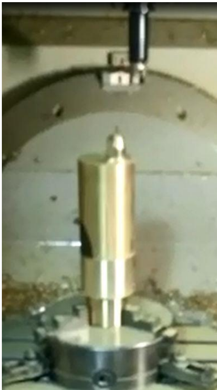
Рис. 65. Завершение черновой обработки головы скульптуры на станке с ЧПУ модели DMG MORI Seiki NMV 5000 DCG
