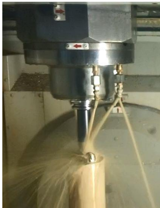
Рис. 64. Черновая обработка головы скульптуры на станке с ЧПУ модели DMG MORI Seiki NMV 5000 DCG (в стадии готовности 2/3)
