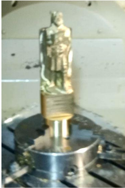
Рис. 69. Завершение фронтальной черновой обработки поясничной части скульптуры на станке с ЧПУ модели DMG MORI Seiki NMV 5000 DCG
