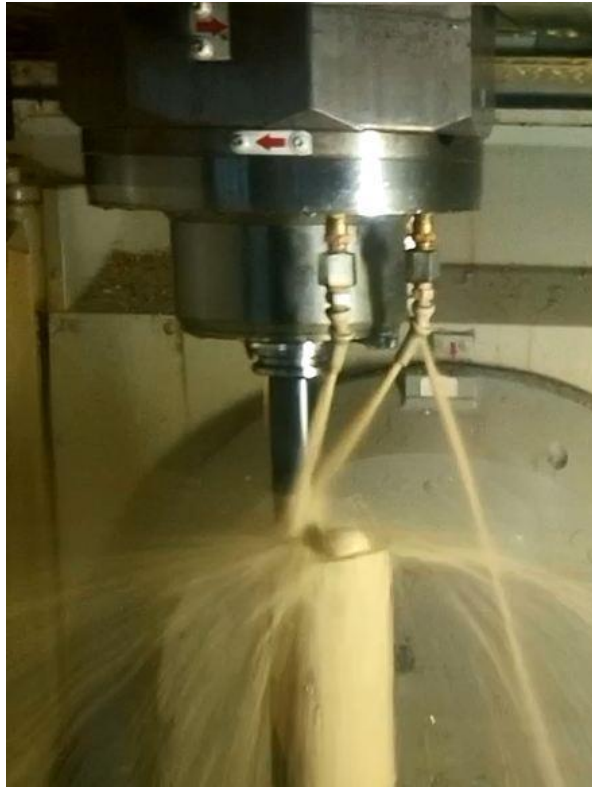
Рис. 63. Процесс черновой обработки головы скульптуры на станке с ЧПУ модели DMG MORI Seiki NMV 5000 DCG (с ближнего расстояния)
