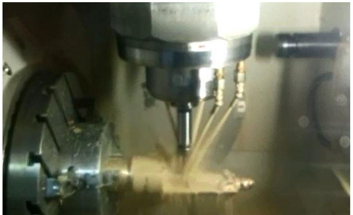
Рис. 68. (г) Идет фронтальная черновая обработка поясничной части скульптуры на станке с ЧПУ модели DMG MORI Seiki NMV 5000 DCG
