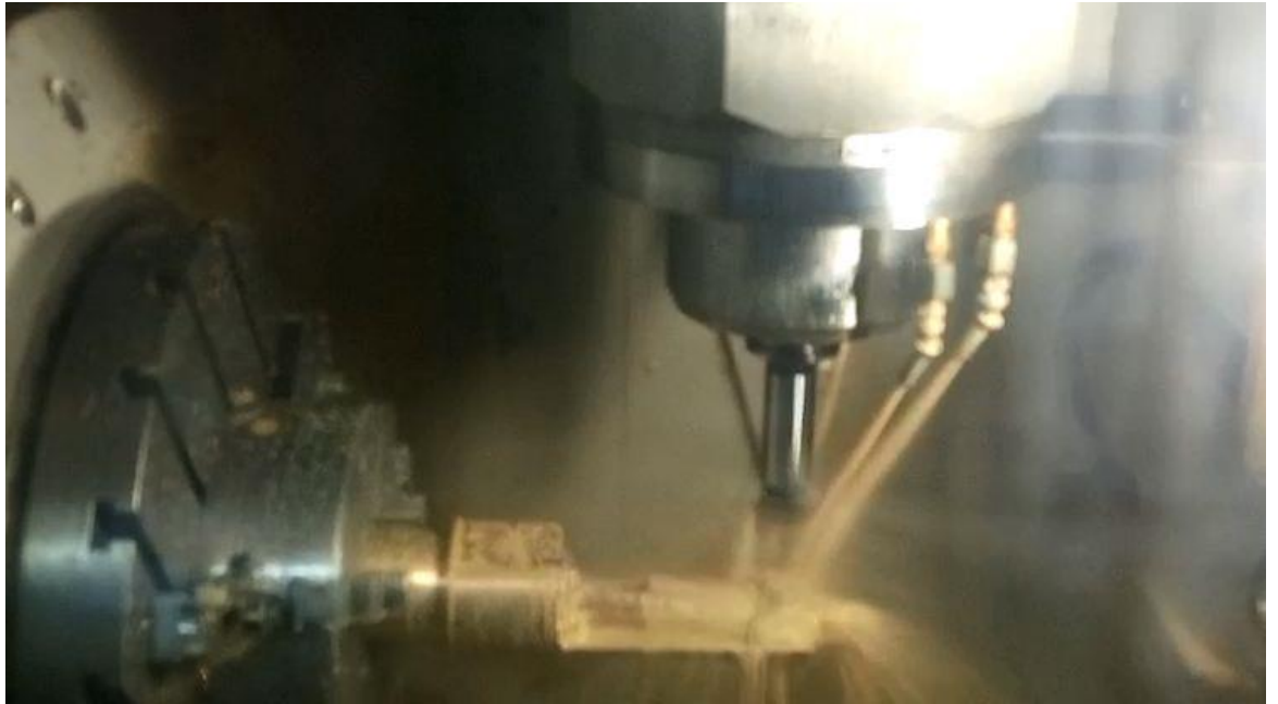
Рис. 68. (в) Идет фронтальная черновая обработка поясничной части скульптуры на станке с ЧПУ модели DMG MORI Seiki NMV 5000 DCG
