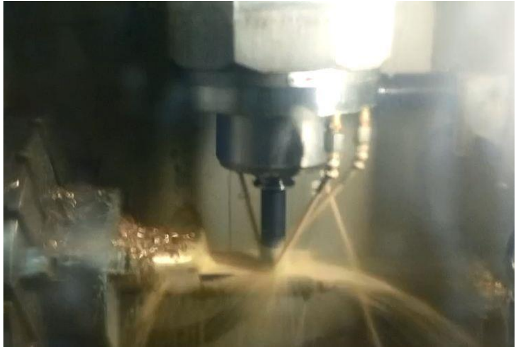
Рис. 68. (а) Идет фронтальная черновая обработка поясничной части скульптуры на станке с ЧПУ модели DMG MORI Seiki NMV 5000 DCG
