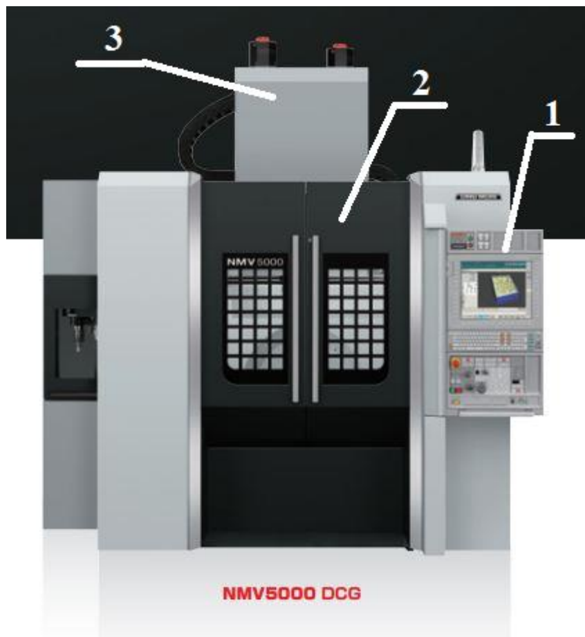
Рис. 28. Станок с ЧПУ модели DMG MORI Seiki NMV 5000 DCG (вид спереди: 1 - панель управления; 2 – двери станка; 3 - суппорт.)
