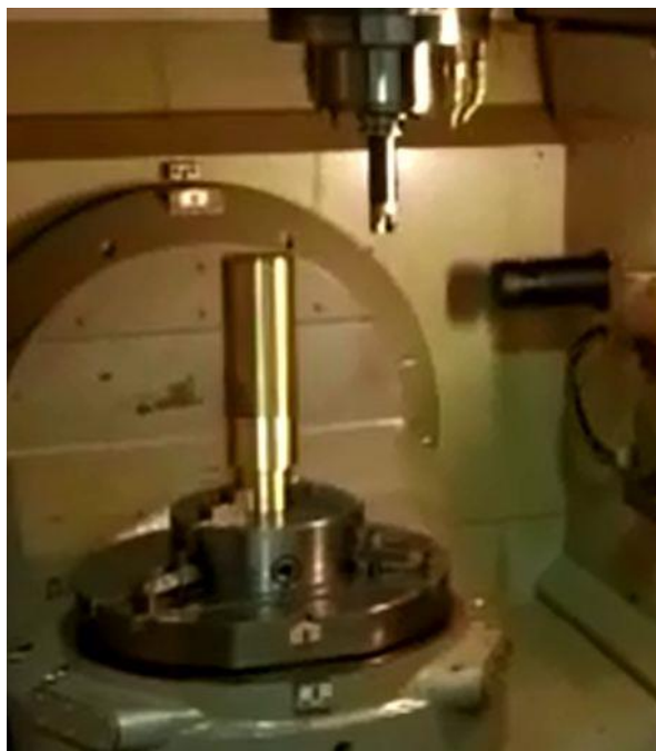
Рис. 61. Подготовка к черновой обработке головы скульптуры на станке с ЧПУ модели DMG MORI Seiki NMV 5000 DCG
