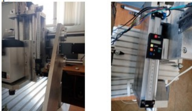
Рис. 3. Установленные на указанные места цифровые линейки
