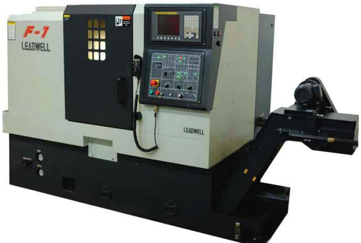
Рис 3.1 Общий вид Токарный станка с ЧПУ Leadwell F1
