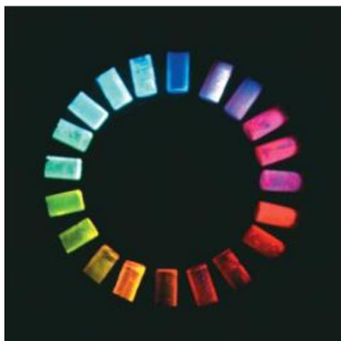
Рисунок 18 – Фотолюминесцентная эмиссия пленок (получены поливом из хлороформа) олиготиофен-S, S-диоксидов 1-15 при УФ-возбуждении при 363 нм
