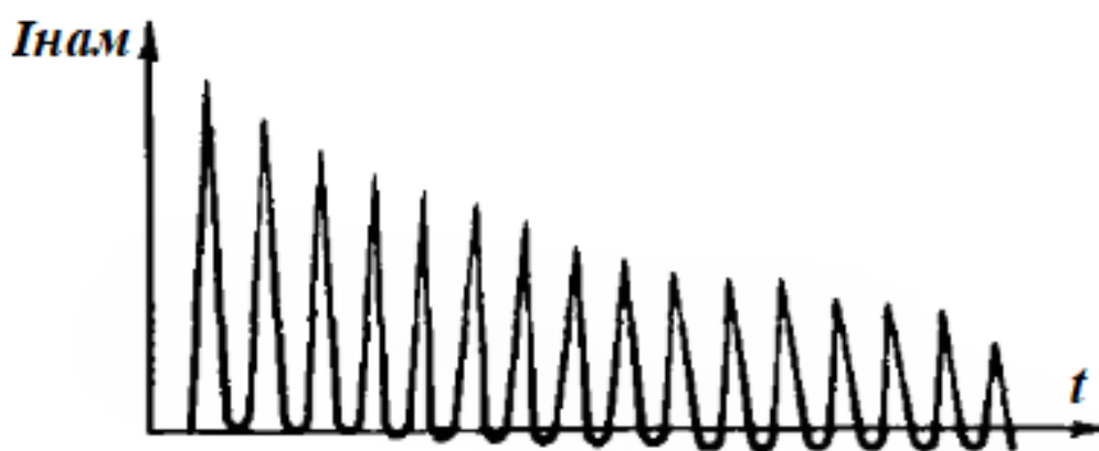
Рисунок 1.10 – Бросок тока намагничивания [1]
