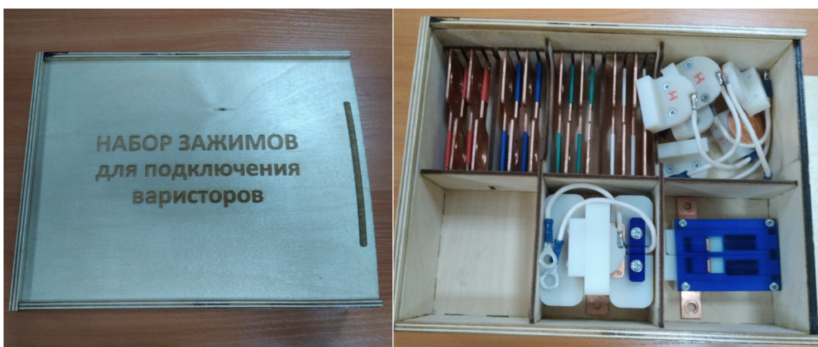
Рисунок А.7 – Сменное крепление под варисторы с выводами для установки на печатные платы
