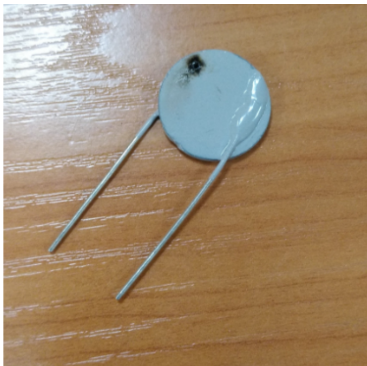
Рисунок А.9 – Один из разрушенных варисторов в ходе предварительной настройки установки
