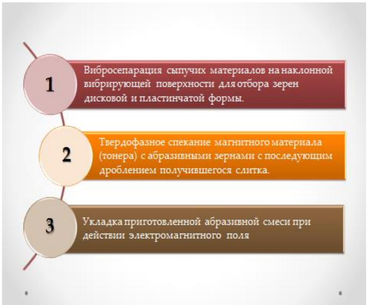
Рис. 16. Этапы оптимизации геометрии абразивных зерен
