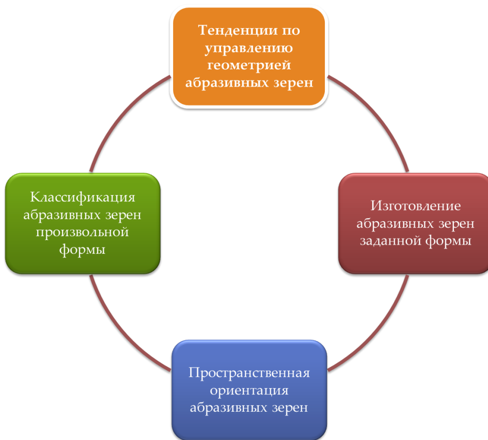
Рис. 9. Методы оптимизации геометрии абразивного зерна
