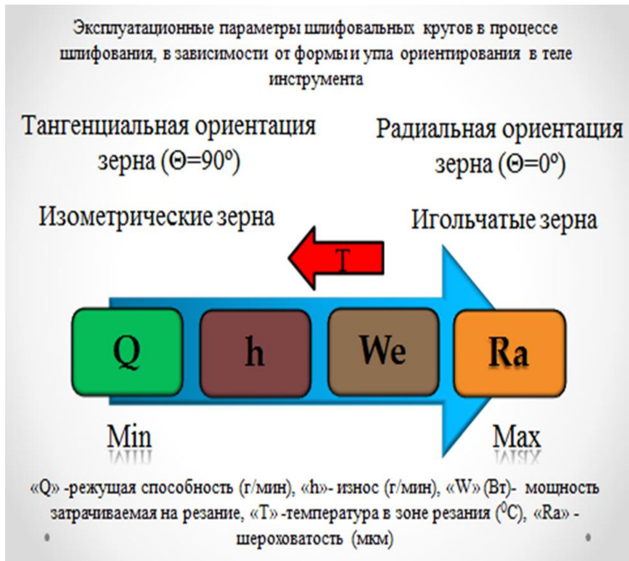
Рис.15. Зависимость эксплуатационных показателей шлифовальных инструментов от формы и ориентации абразивных зерен
