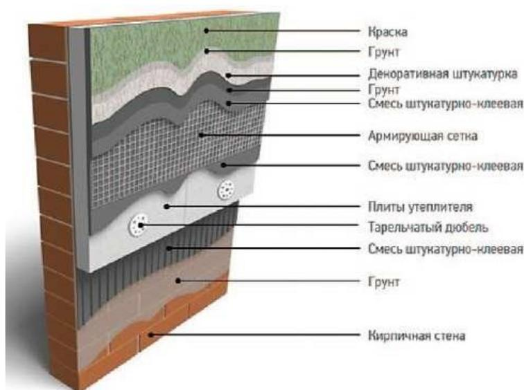
*Рисунок 12 – Схематичный разрез системы утепления «Мокрый фасад»*
