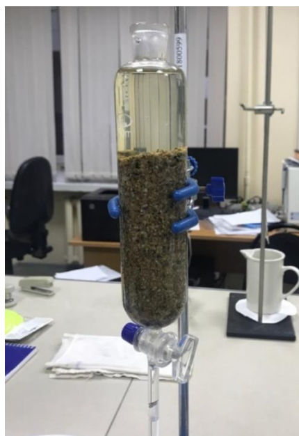
Рисунок 2.5 – Делительная воронка в качестве фильтра второй ступени: окислитель - гипохлорит натрия, загрузка - «Бризант»
