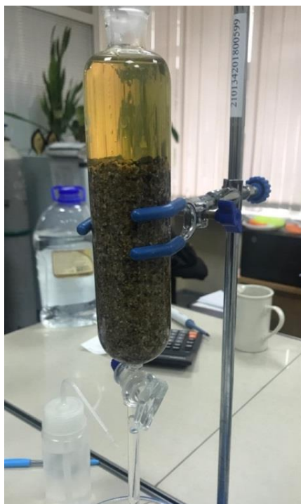
Рисунок 2.6 – Делительная воронка в качестве фильтра второй ступени с использованием в качестве окислителя перманганат калия, а загрузки «Бризант»
