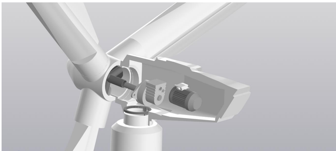
Рисунок 3.9 – Внутреннее устройство ветроагрегата 500 кВт с редукторным приводом
