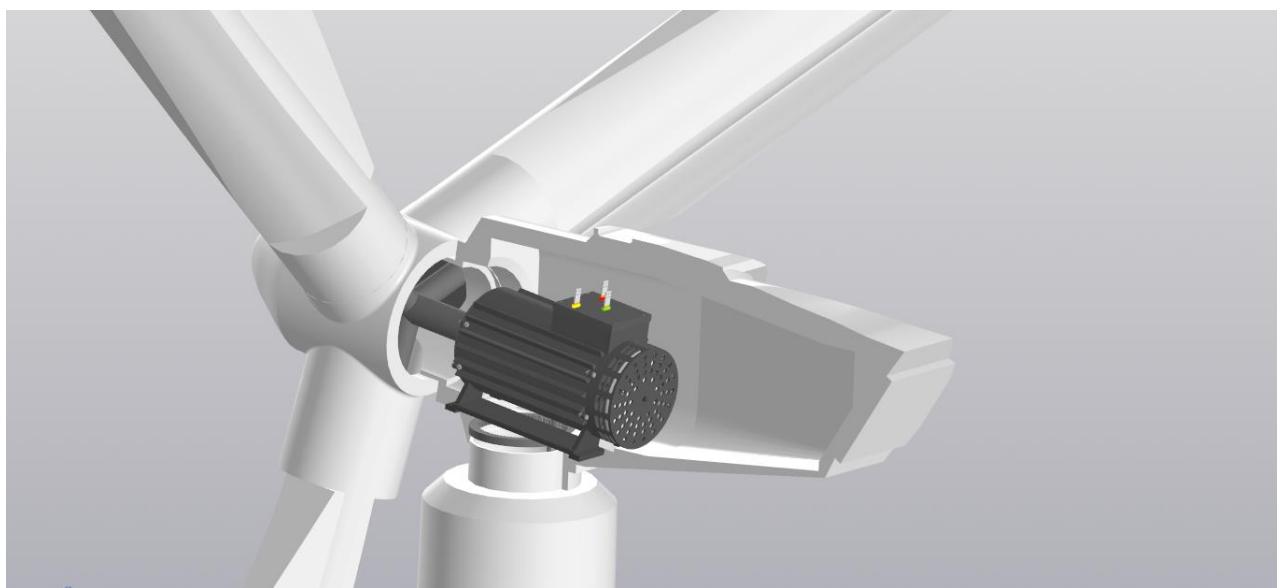
Рисунок 3.10 – Внутреннее устройство исходного ветроагрегата 500 кВт с использованием спроектированного генератора
