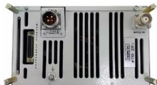
Рисунок 21 – Генератор ВЧ «ИВЭ-171RFS»
