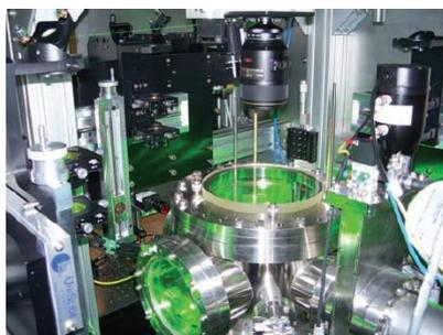
Рисунок 3 – Вид газоразрядной ВЧ-камеры GEC-RF-Reference Cell
