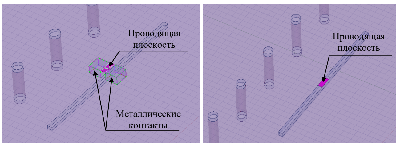
Рис. 2.9 Модели установленного посередине щели резистора в Ansys HFSS.
