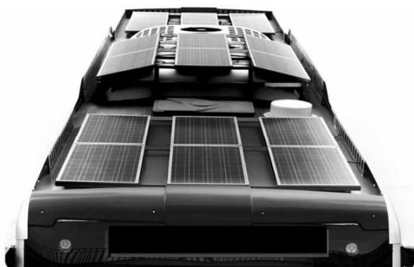
Рисунок 2.10 - Солнечные панели на крыше электробуса Ikarus
