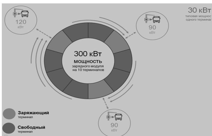
Рисунок 3.6 - Схема распределения мощностей в терминалах
