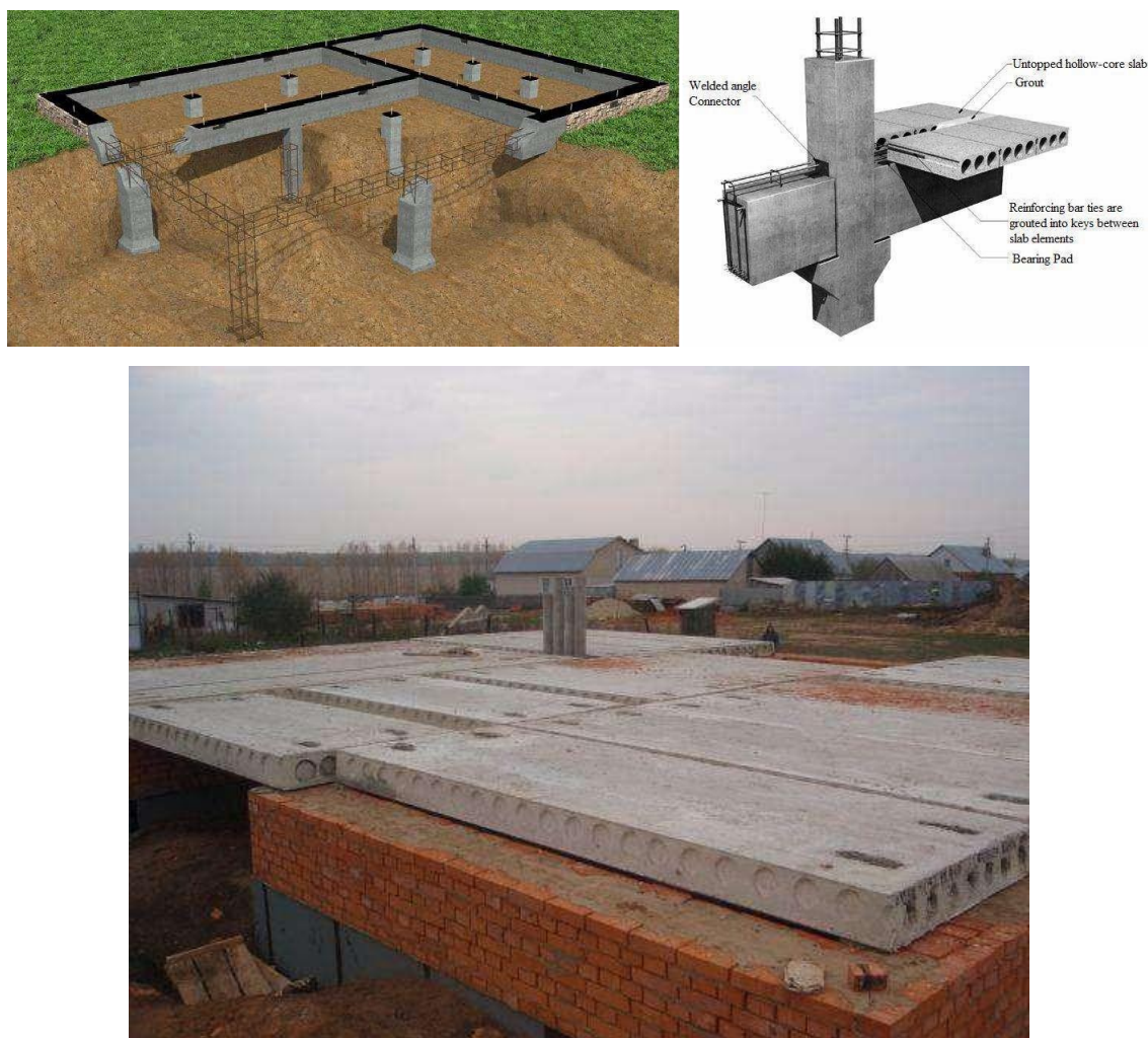
Рисунок 2.2 – Схема крепления свайно-ленточного фундамента
