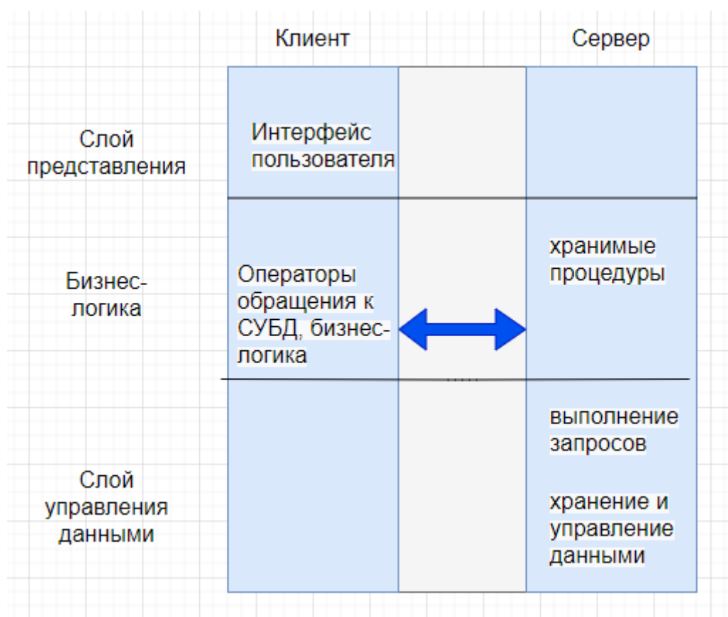
Рисунок 16 – Клиент – серверная архитектура с сервером СУБД
