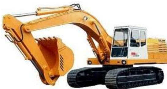
ЭО-4121 выпускается со сменным рабочим оборудованием (обратной или прямой лопатой, погрузчиком, грейфером) и ковшами емкостью от 0,65 до 1,5 кубометров.
