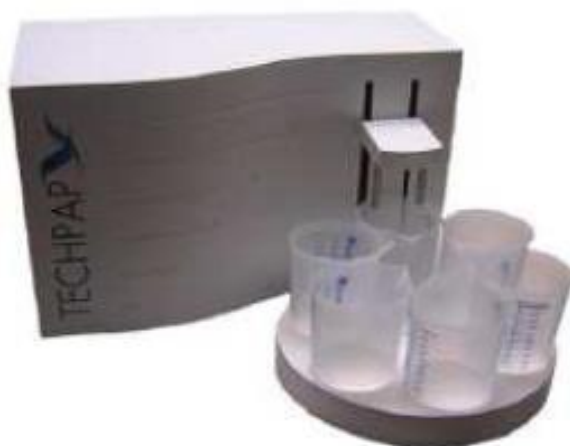
Рисунок 1 – Прибор для морфологического анализа волокна MorfiCompact
