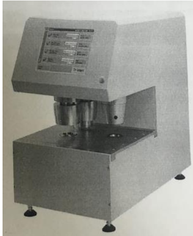
Рисунок 3 – Прибор для определения шероховатости и воздухопроницаемости
