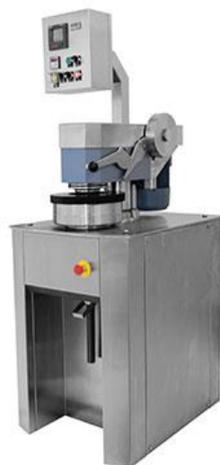
Рисунок 2 – Мельница PFI для размола целлюлозы
