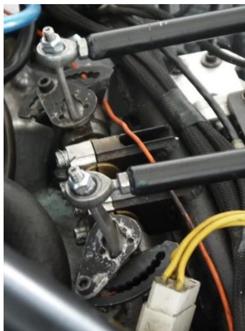
Рисунок 12 – Конструкция СПУ с регулировкой жесткости путём изменяемым сечением пластины.
