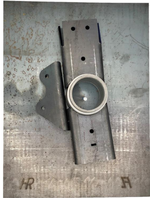
Рисунок 95 – Изготовленные кондуктор: а – общий вид; б – примерное расположение деталей для сборки
