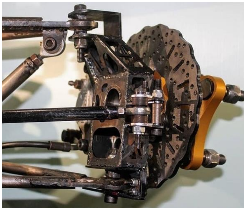
Рисунок 10 – Передний поворотный кулак болида команды Formula Student Team of MIT-WPU
