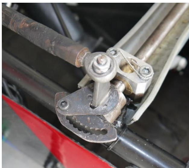
Рисунок 12 – Конструкция СПУ с регулировкой жесткости путём изменяемым сечением пластины.
