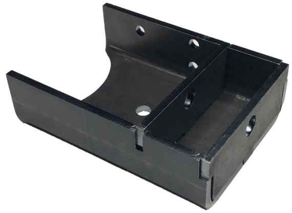
Рисунок 93 – Изготовленные верхние и нижние части передних поворотных кулаков: а – верхняя часть кулака; б – нижняя часть кулака
