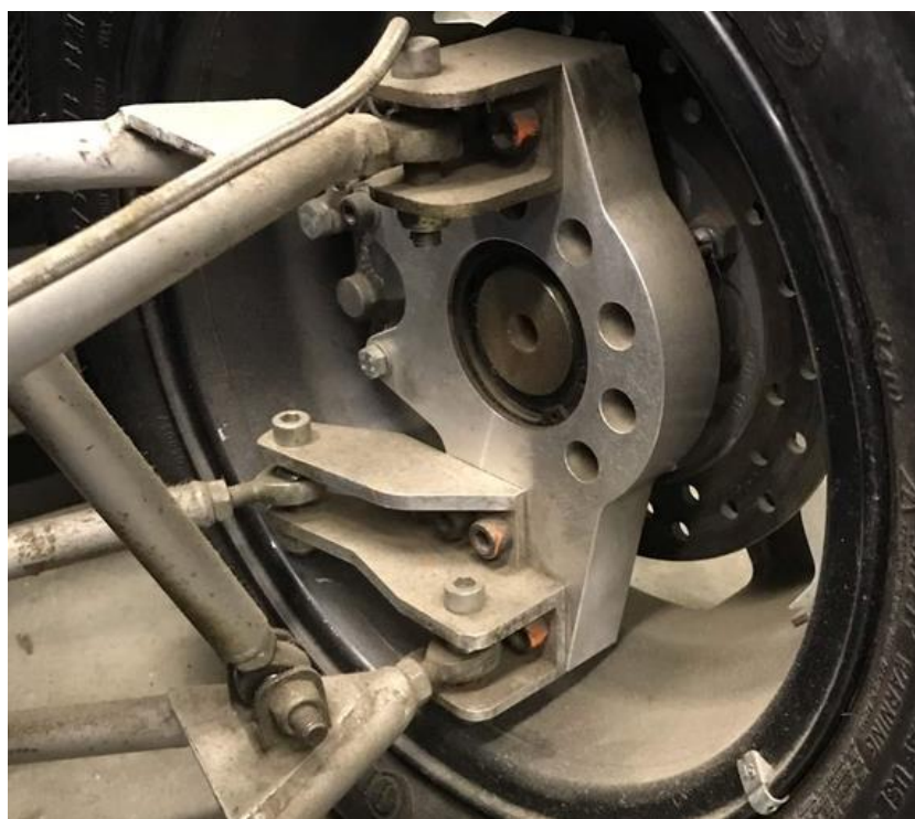
Рисунок 5 – Передний поворотный кулак болида «Iguana EVO» команды FDR Moscow
