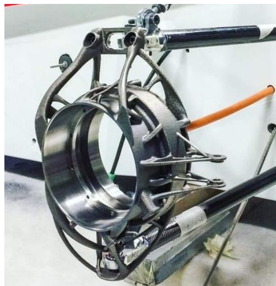
Рисунок 8 – Передний поворотный кулак, изготовленный на 3d принтере команды Formula Student from Trondheim: a – контроль геометрии изготовленной детали; б – установленный на болид поворотный кулак.
