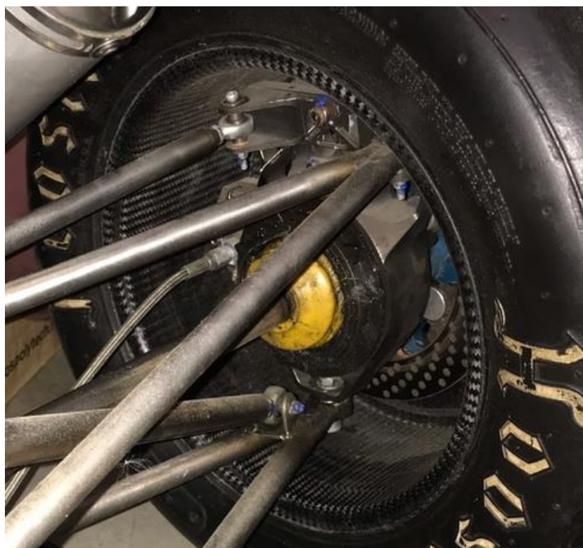
Рисунок 6 – Задний поворотный кулак болида «Iguana G10t1» команды FDR Moscow
