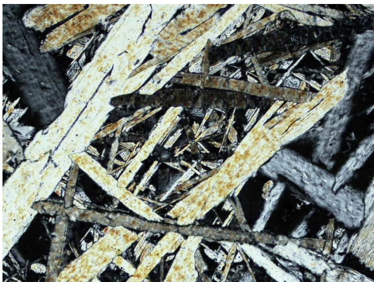
Рисунок 1.3 – Структура литого слюдокристаллического материала, x150
