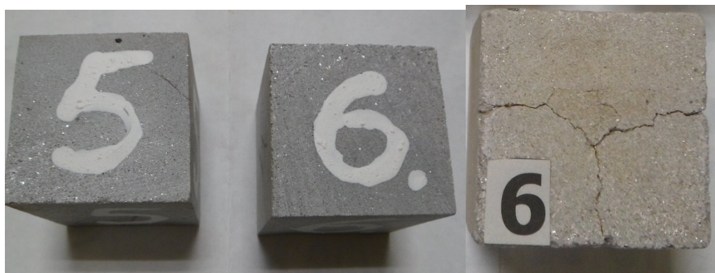
Рисунок 4.12 – Образцы литого слюдокристаллического материала на основе габбродолерита с добавкой кремнефтористого калия в количестве 10%: а – до испытаний, б – после испытаний
