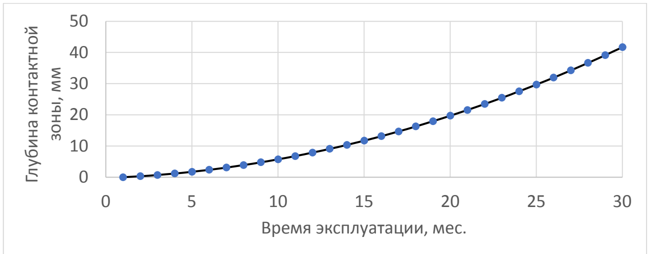
Рисунок 4.22 – Изменение глубины контактной зоны на поверхности огнеупорных изделий из литого слюдокристаллического материала в зависимости от срока эксплуатации
