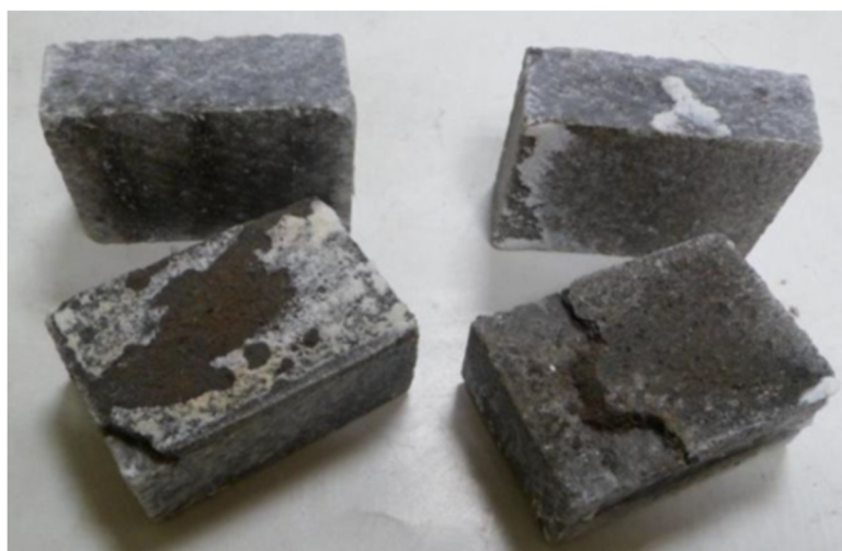
Рисунок 5.12 – Образцы шовных соединений изделий из литого слюдокристаллического фторфлогопита после испытаний в элеткролизере
