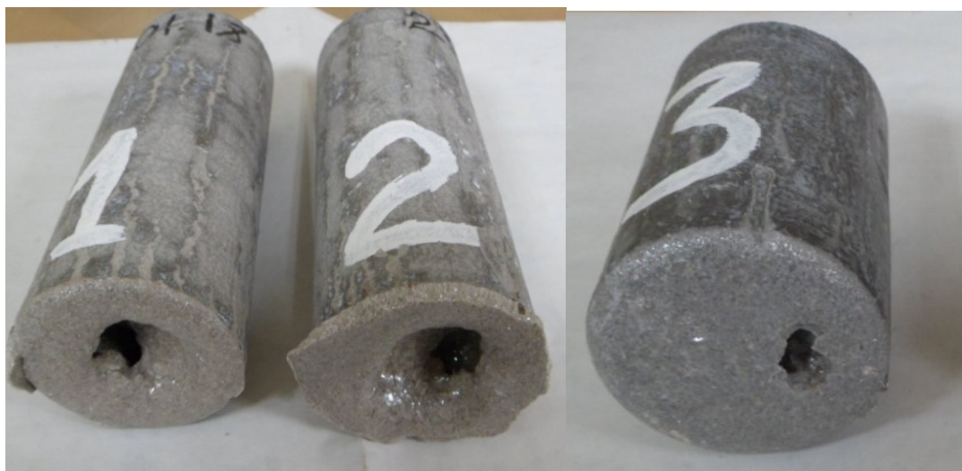
Рисунок 5.10 – Образцы литого слюдокристаллического материала с различным количеством возвратных материалов в шихте до испытаний
