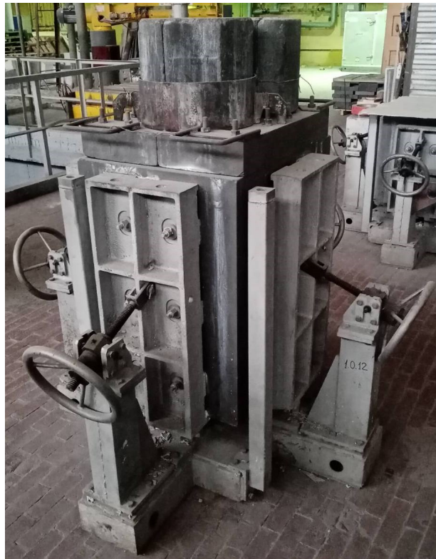
Рисунок 5.5 – Графитовый кокиль с металлической оснасткой
