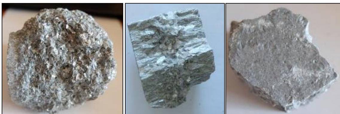
Рисунок 2.10 – Откольные образцы литого слюдокристаллического материала фторфлогопитового типа
