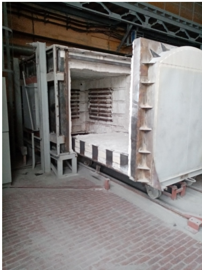
Рисунок 5.9 – Термическая обработка отливок: а – загрузка в печь, б – печь для термообработки перед загрузкой
