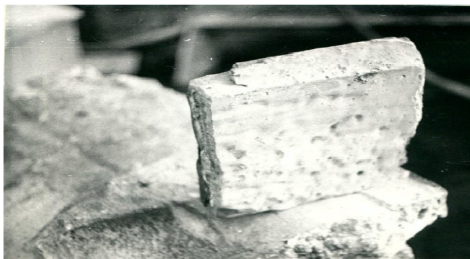
Рисунок 4.20 – Часть угловой защиты, извлеченная из электролизера после 30 месяцев непрерывной эксплуатации
