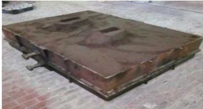
Рисунок 5.6 – Разовая форма перед заливкой
