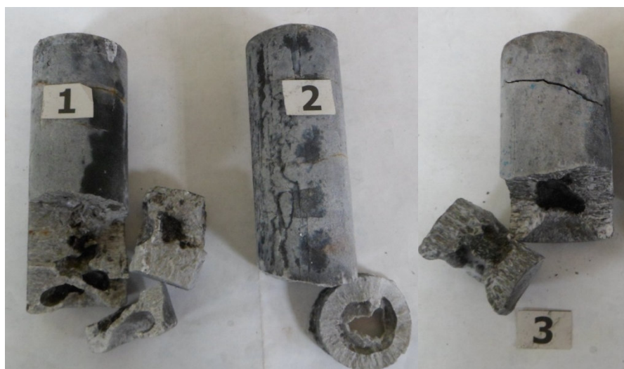
Рисунок 5.11 – Образцы литого слюдокристаллического материала с различным количеством возвратных материалов в шихте после испытаний
