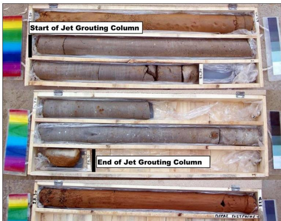
Рис. 2.14. Керны из грунтоцементной колонны (ГЦК): сверху керны отобранные ближе к поверхности земли; снизу – отобранные у пяты ГЦК [120].
