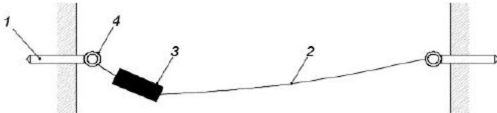
Рис. 2.24. Принципиальная схема ленточного экстензометра: 1 - анкерный болт (с резьбовым соединением или проушиной); 2 - измерительная стальная лента (или струна); 3 - устройство натяжения ленты (струны) и измерительное устройство; 4 - соединение (резьбовое либо проушина - крюк) [127].
