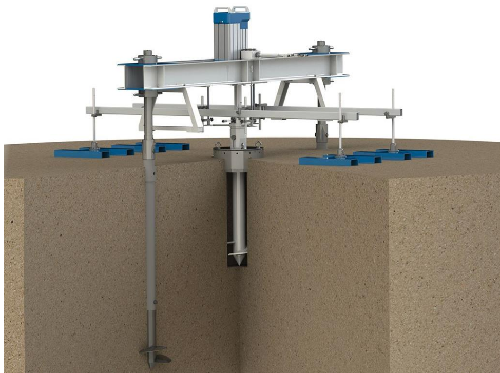
Рис. 2.21. Схема испытаний винтовым штампом в массиве [124].
