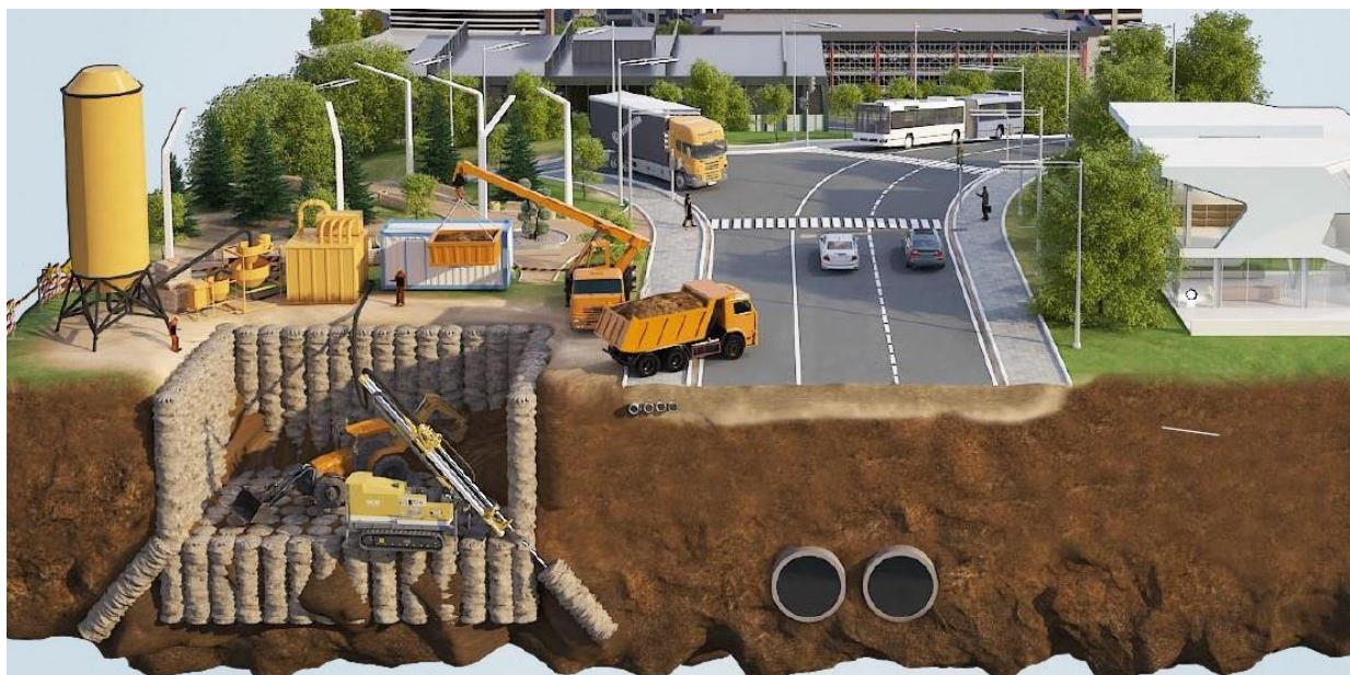
Рис. 2.5. Ограждение котлована, выполненное с помощью струйной цементации [114].
