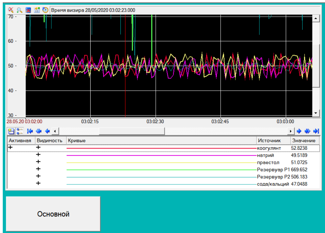
Рисунок 12 – Графики уровня в резервуарах с чистой водой и в баках с химическими реагентами
