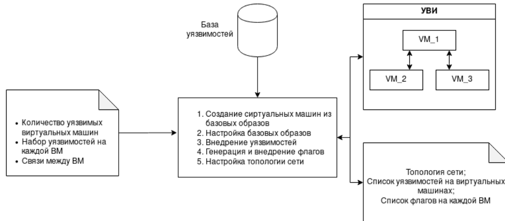
Рис. 4. Архитектура программного продукта
