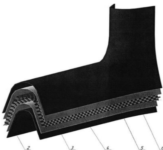
Рисунок 1.5 – Сотовая трёхслойная панель сложной кривизны, где 2,6 – нижний и верхние слои, 3,5 – пленочный клей, 4- сотовая конструкция
