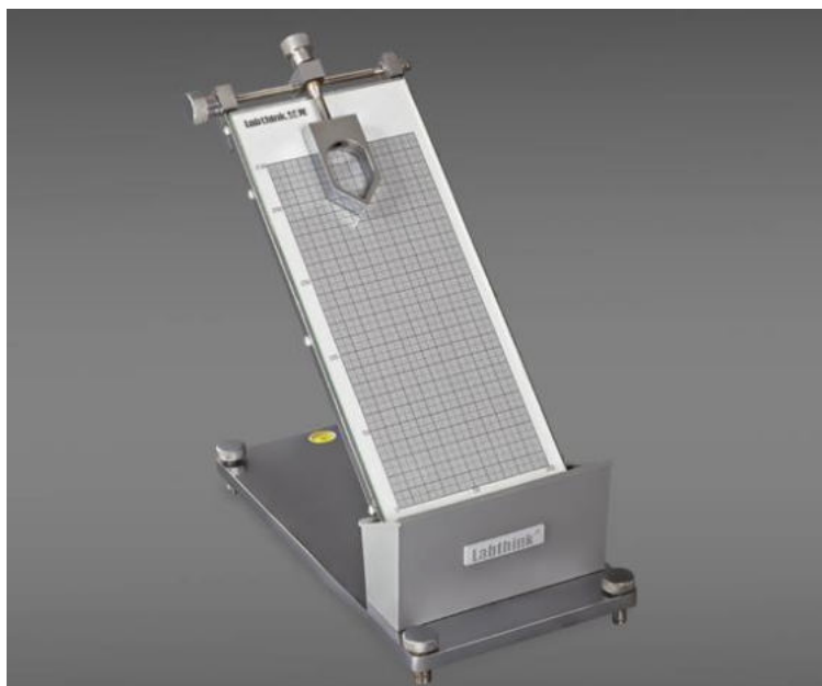
Рисунок 2.10- Прибор для измерения липкости
