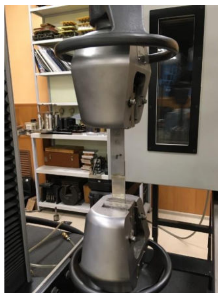
Рисунок 2.12 – Зажим образца при помощи вспомогательной оснастки на сдвиг
