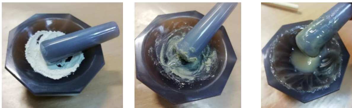
Рисунок 3.1 – Технология смешивания смолы и глины
