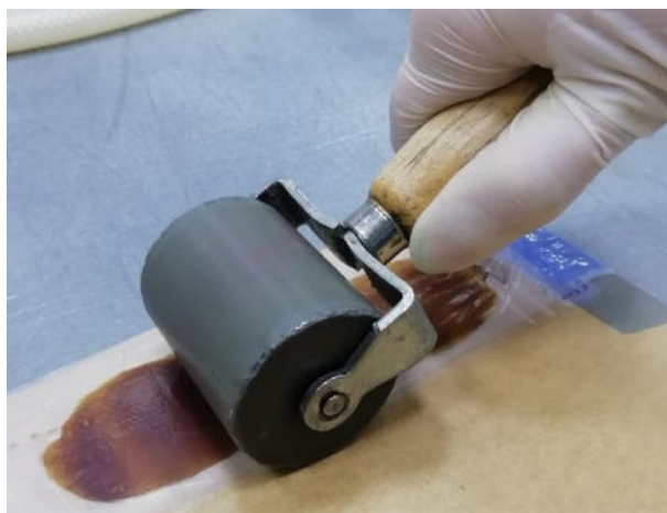
Рисунок 3.15 – Процесс получения пленочного клея прикаткой роликом
