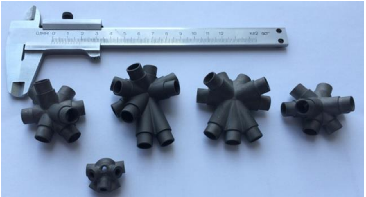
Рисунок 2 – Внешний вид фитингов, созданных по технологии SLM [21]
