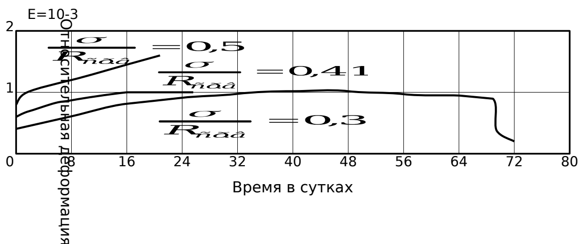
Рис.4.5. Деформация ползучести жаростойкого шамотного бетона на КВ при нормальной температуре
