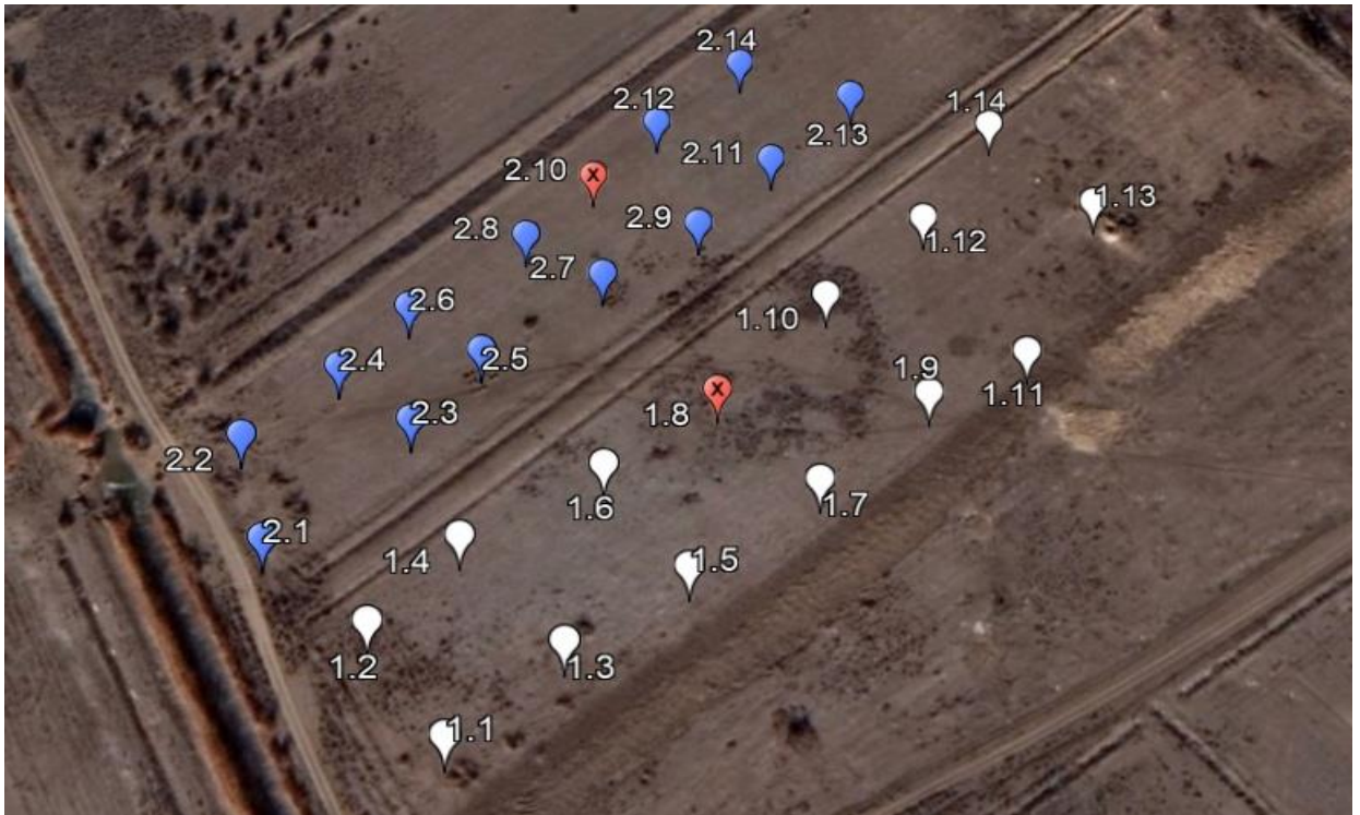
Рисунок 2 – Схема расположения прикопок на территории исследуемого объекта
