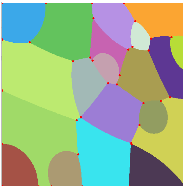
Рис.2 результат работы заполнения области и поиска ключевых узлов
