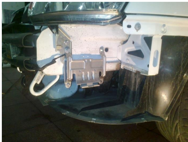
Рис. 3.1. Специальный кронштейн для установки предпускового подогревателя
