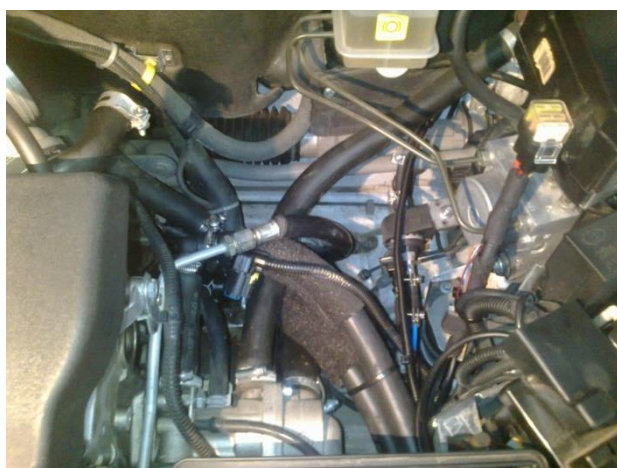
Рис. 3.2. Процесс «врезки» циркуляционных шлангов в общую систему охлаждения
