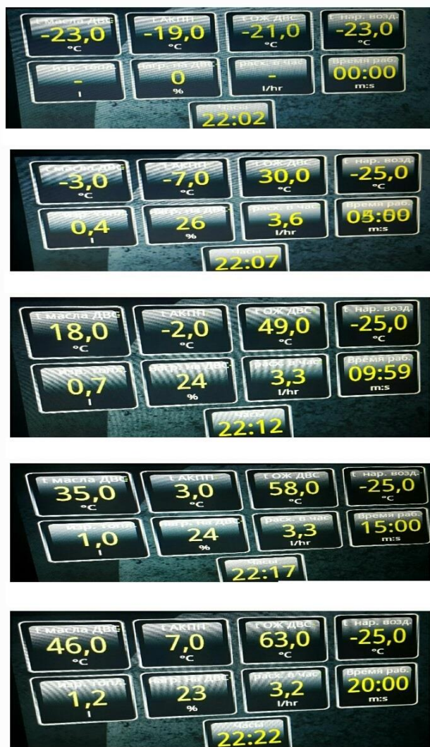
Рис. 3.8. Показания, полученные при прогреве двигателя на «холодную» без предпускового подогревателя
