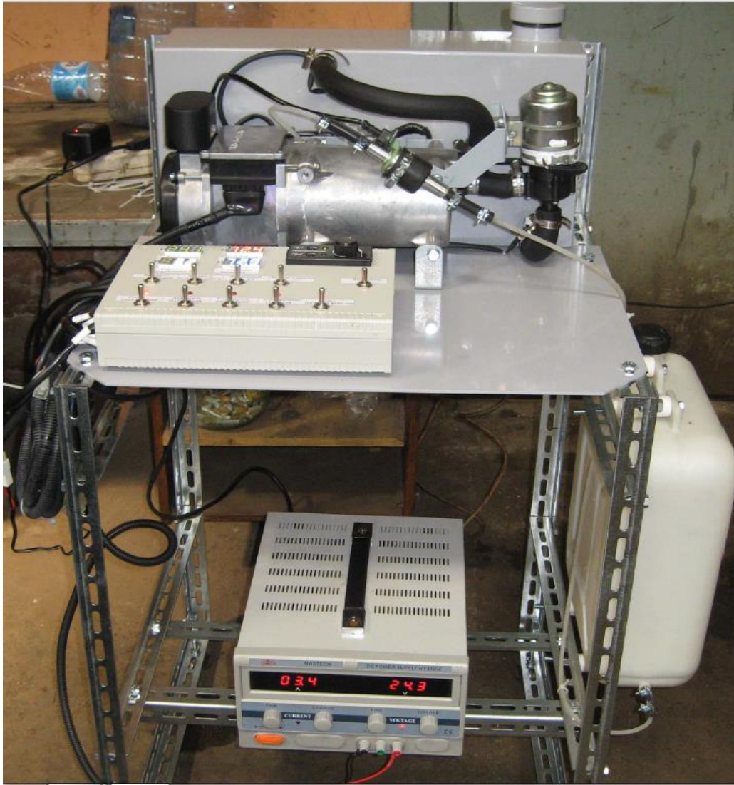
Рис. 3.10. Фотографии стенда для проверки функционирования различных видов предпусковых подогревателей
