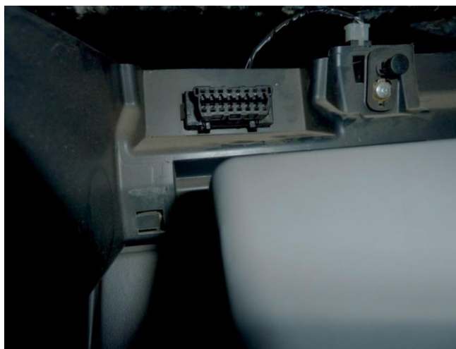
Рис. 3.3. Специальный диагностический разъём OBDII
