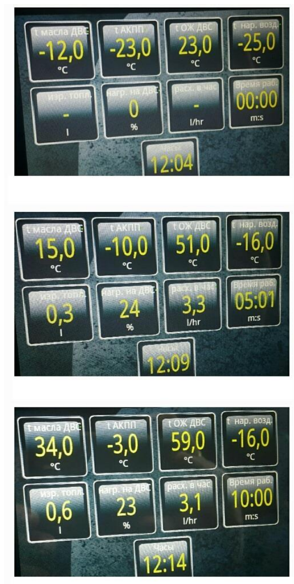
Рис. 3.9. Показания, полученные при работающем двигателе через 25-30 минут работы отопителя
