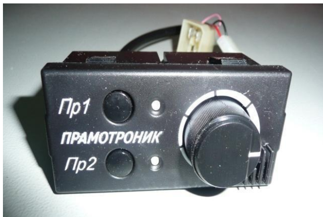
Рис. 3.13. Пульт непосредственного управления подогревателем
