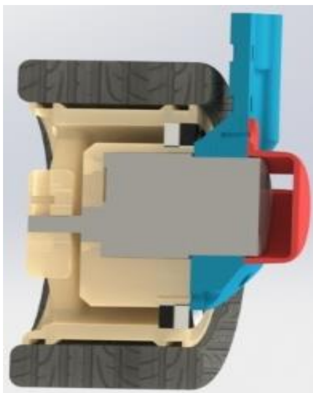
Рисунок 22 – Разработанная модель колесного блока, вид в разрезе
